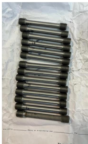
**Slika 10.** Epruvete označene brojevima 1-14
