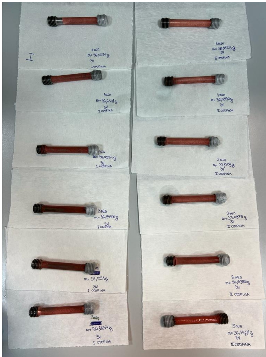
Slika 14. Epruvete odmah nakon pobakrivanja u kupkama (I) i (II)
