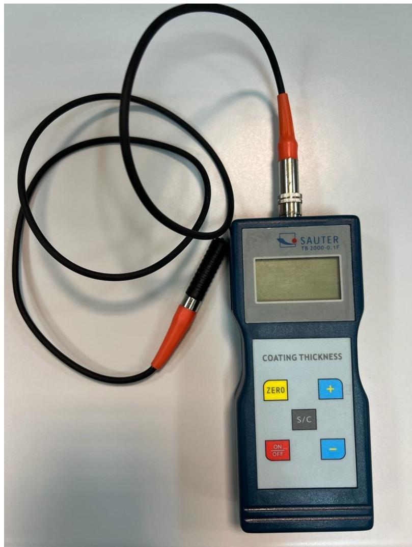
**Slika 15.** Uređaj za mjerjenje bakrenih prevlaka
