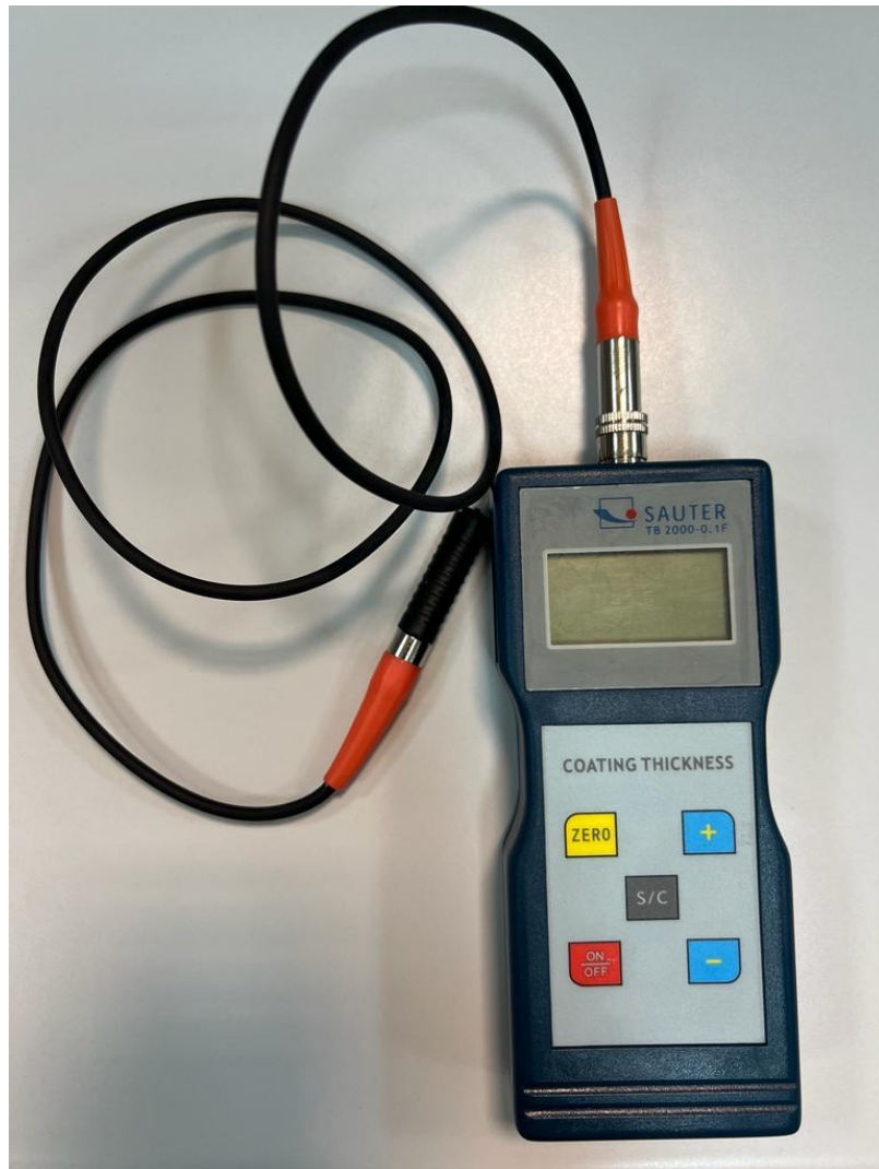
Slika 15. Uređaj za mjerenje bakrenih prevlaka
