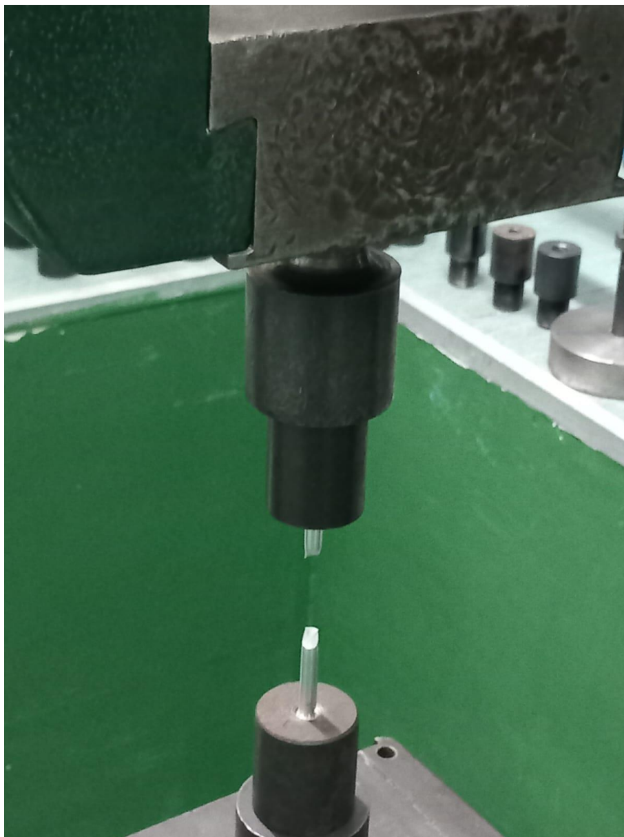
Slika 9. Položaj puknuća epruvete u kidalici
