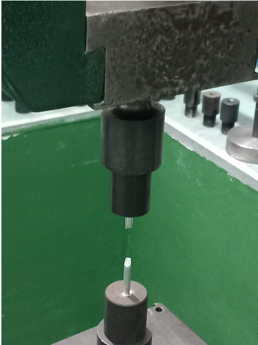
Slika 9. Položaj puknuća epruvete u kidalici
