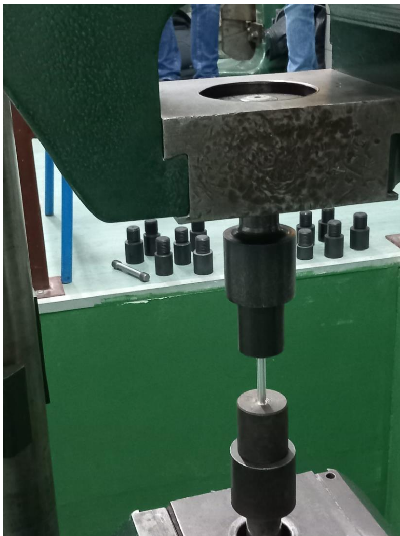
Slika 8. Položaj epruvete u kidalici prije ispitivanja
