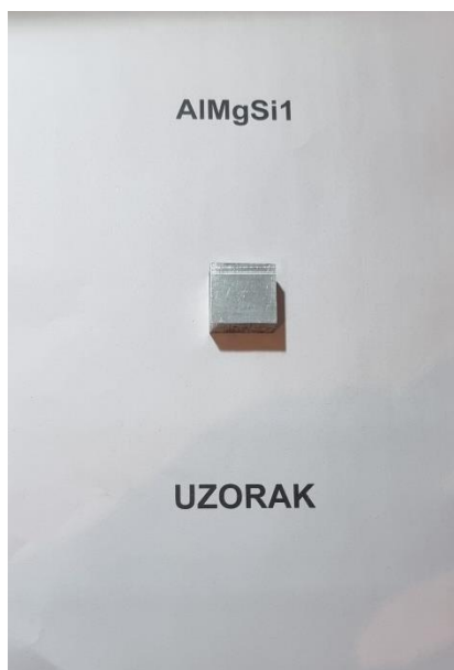
Slika 13. Označeni uzorak AlMgSi1 legure nakon ispitivanja na tvrdomjeru
