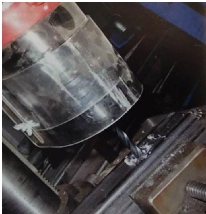
Slika 11. Zaštitni prsten od pleksiglasa oko rotirajućeg dijela bušilice [5]
