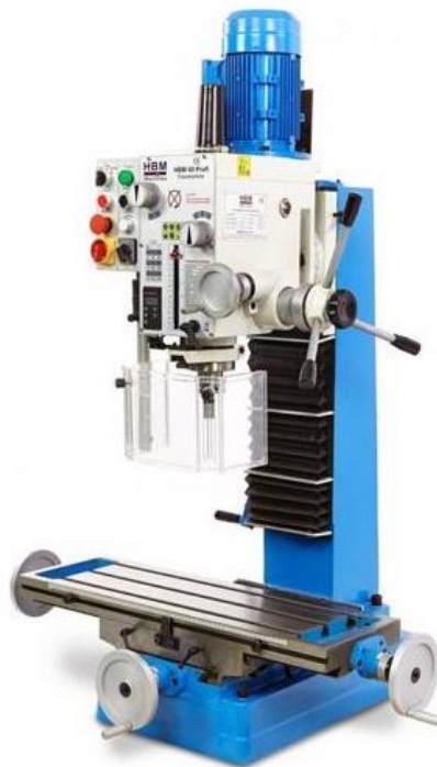
Slika 13. Opasnosti rada na vertikalnoj glodalici uključuju zahvaćanje odijela radnika s vretenom, pucanje alata uslijed greše alata ili u radu, izmicanje ili odlijetanje obratka, opasnosti od prijenosnih elemanta, zakrčenosti radnog mjesta, poskliznuća, letećih strugotina ili neispravnih instalacija [10]
