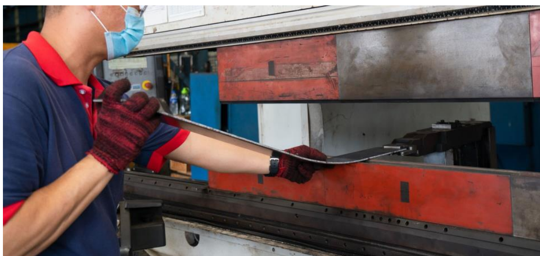
Slika 17. Rad na stroju za savijanje lima [18]
