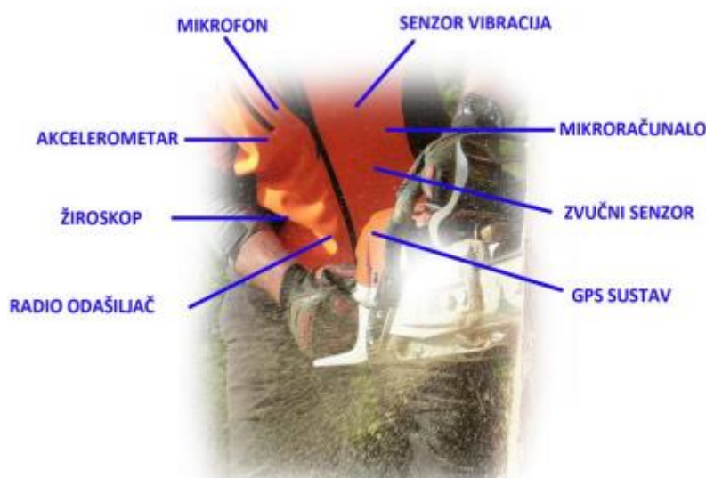
Slika 6. Inteligentna jakna za nadzor rada šumskih radnika [12]
