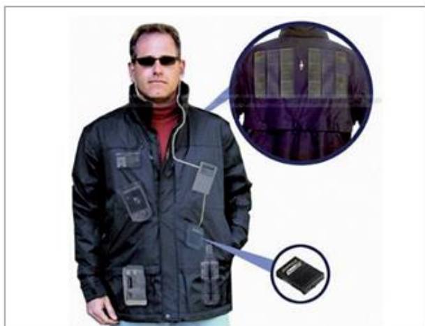
Slika 3. Ugrađeni fleksibilni fotonaponski paneli na leđima inteligentne jakne [3]
