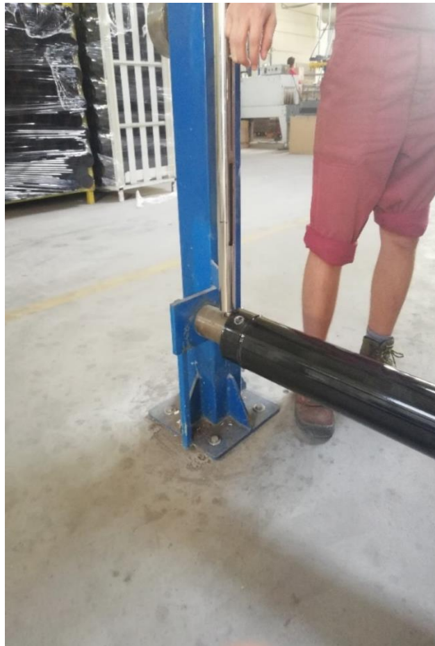
Slika 18. Postupak ispitivanja prionjivosti emajla [11]
