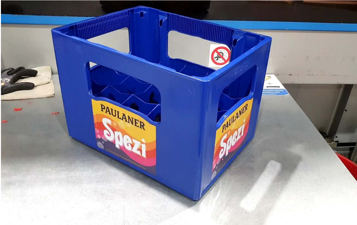
Slika 12. Nosiljka za boce izrađena injekcijskim prešanjem
