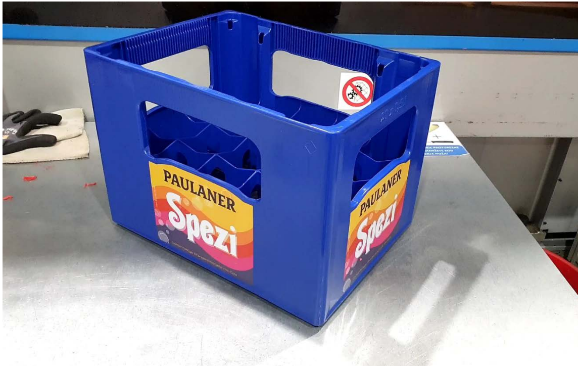
Slika 12. Nosiljka za boce izrađena injekcijskim prešanjem
