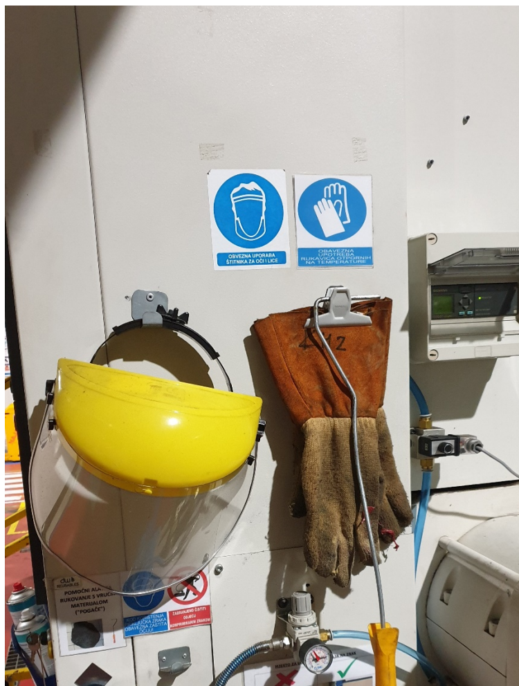
Slika 14. Zaštitni vizir i rukavice otporne na visoku temperaturu
