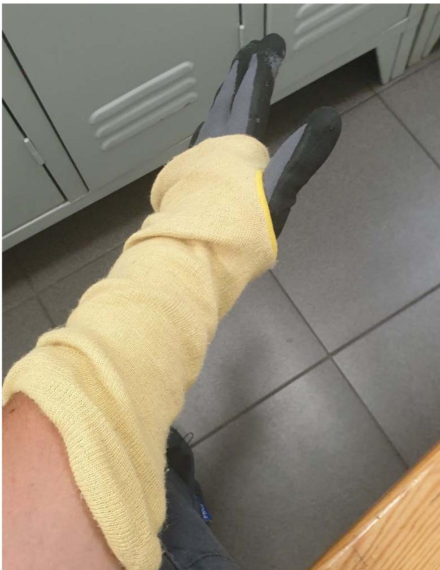
Slika 10. Proturezne rukavice i zaštitna manžeta za zaštitu podlaktice
