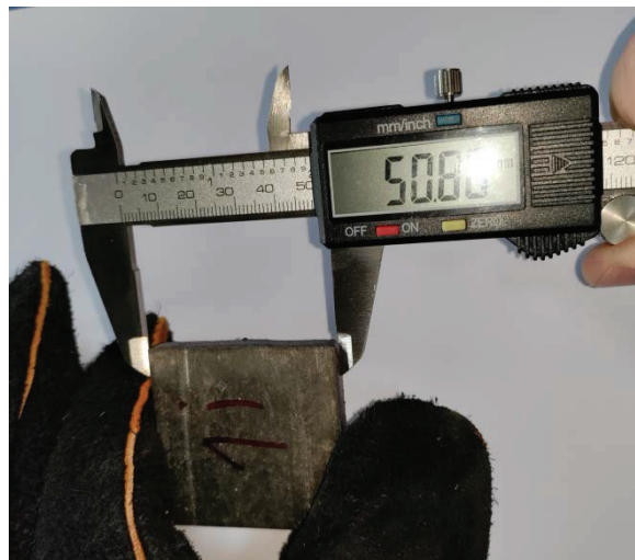
Slika 31.: Provjera prve dimenzije na obratku
