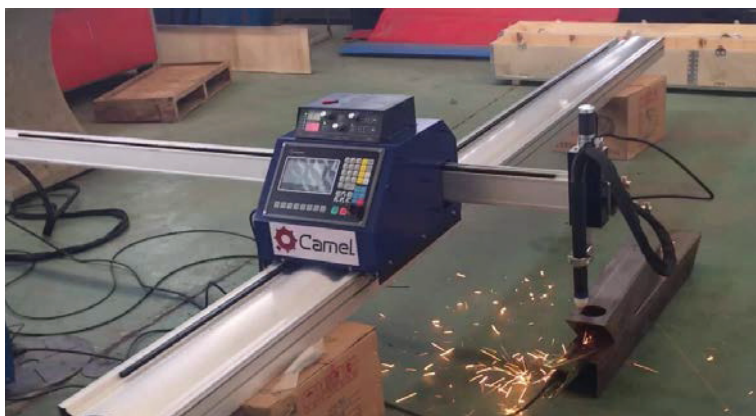
Slika 10.: Rezanje sa prijenosnom CNC plazmom
