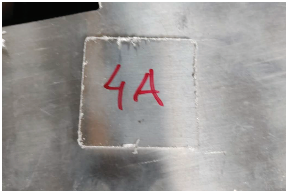
Slika 44.: Poleđina četvrtog obradka na kojoj ima srh
