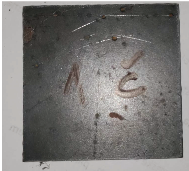
Slika 24.: Prvi izrezani obradak iz čelične pločevine
