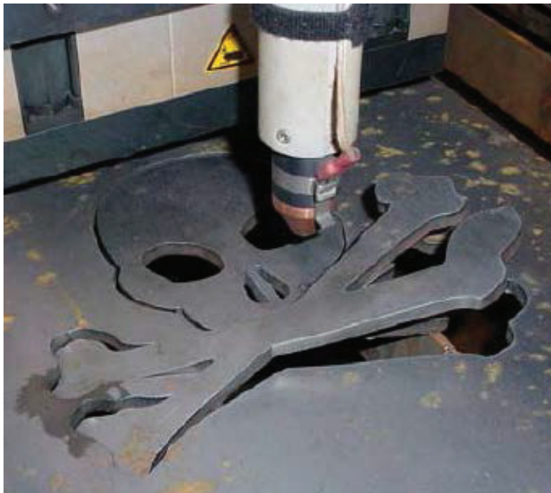
Slika 17.: Izrezani dio obratka je iskočio iz pozicije i može uzrokovati sudar
