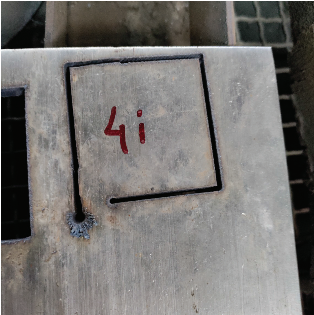
Slika 35.: Četvrti rez nije uspio
