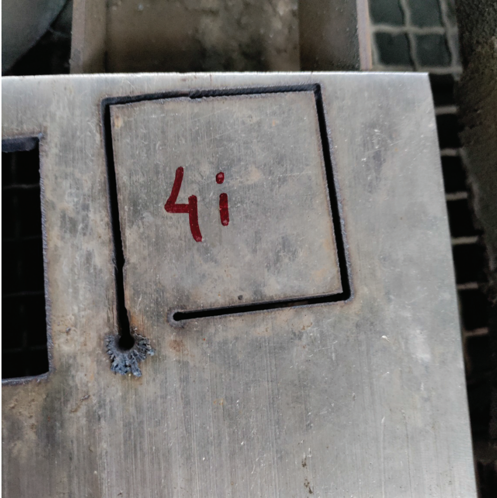
Slika 35.: Četvrti rez nije uspio
