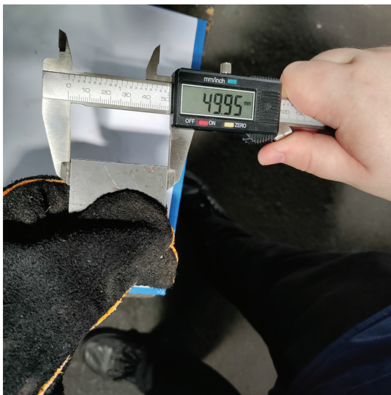
Slika 26.: Mjerenje druge dimenzije pomičnim mjerilom
