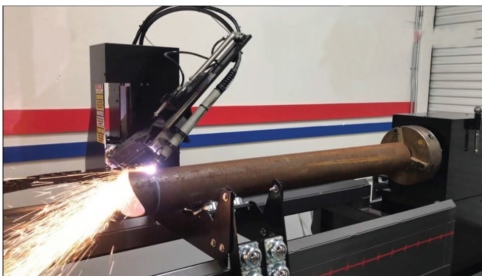
Slika 14.: Rezanje cijevi na CNC plazmi za cijevi
