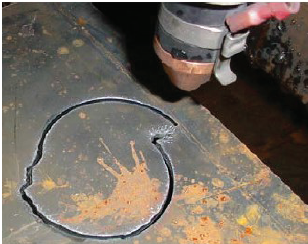
Slika 18.: Gubitak pozicije tijekom rezanja
