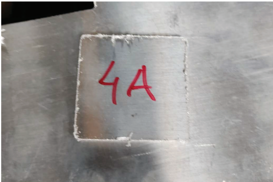
Slika 44.: Poleđina četvrtog obradka na kojoj ima srh
