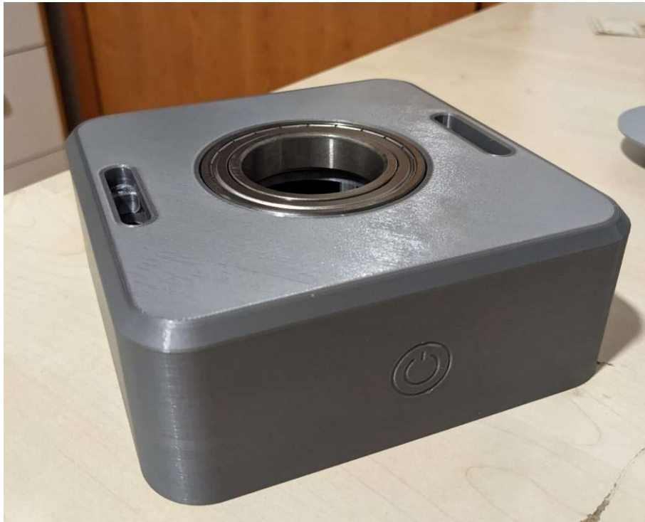
Slika 39 Tijelo kućišta s ležajem [8]
