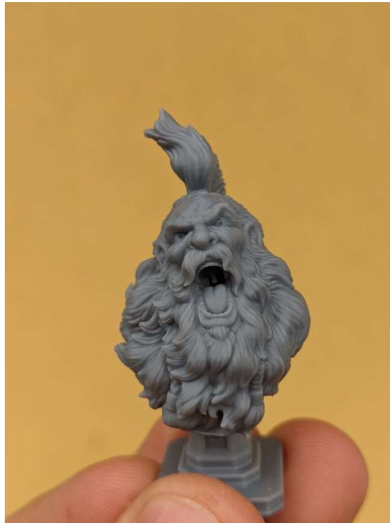
Slika 7 Figura Ispisana SLA tehnologijom [8]
