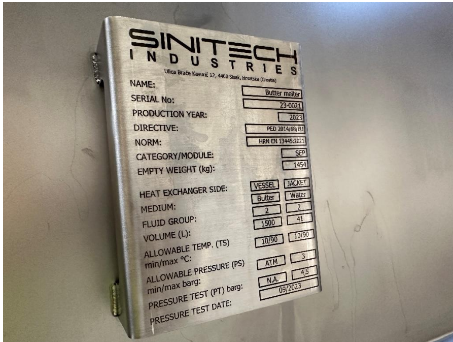
Slika 15. Primjer laserskog graviranja na Inox (304) materijalu, prije obrade materijala bilo je potrebno ispolirati pločicu
