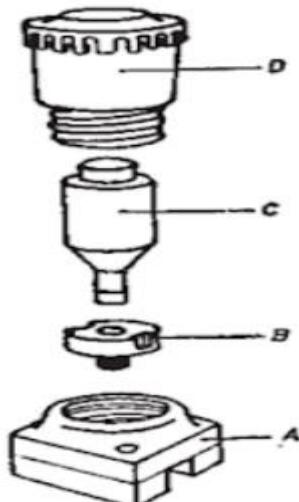
Slika 7. „Dijelovi osigurača tipa D“ [11]
