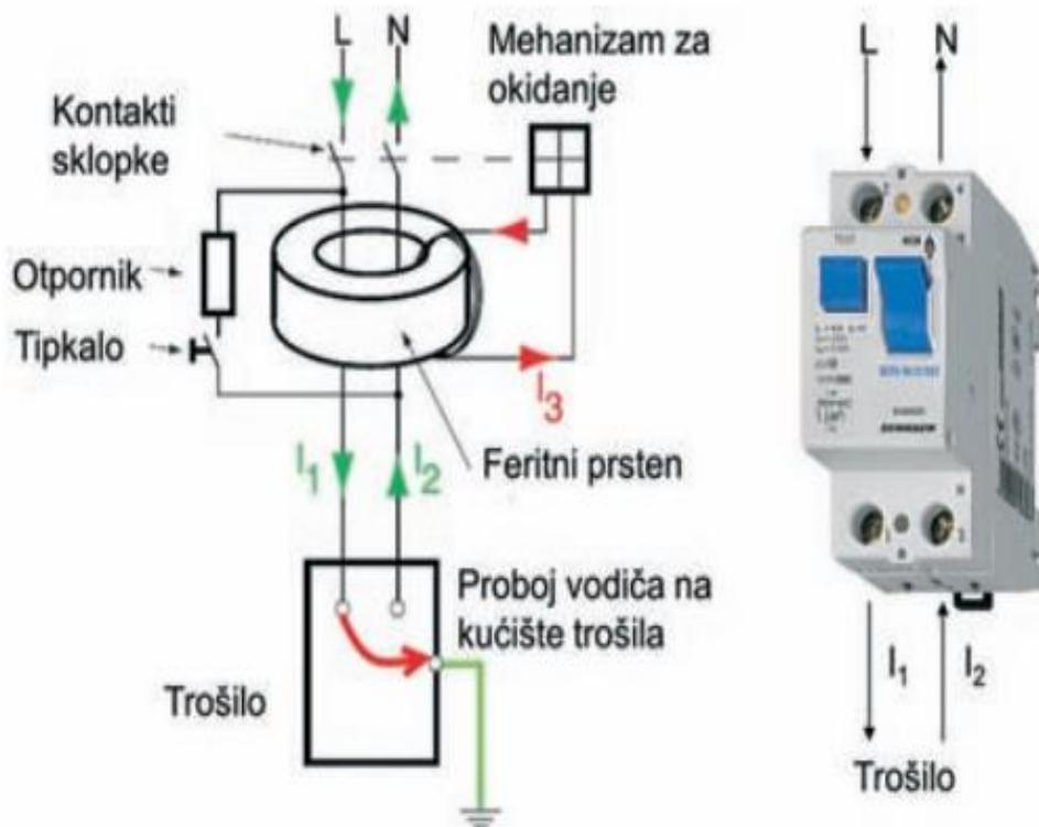
Slika 9. „Princip djelovanja diferencijalne sklopke“ [15]
