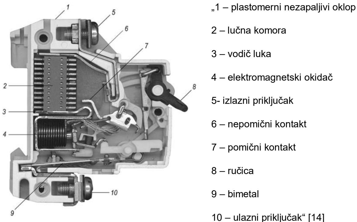
Slika 8. „Dijelovi automatskog osigurača“ [14]
