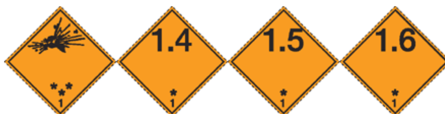
Slika 3. Dopunske oznake za prevoženje eksplozivnih sredstava
