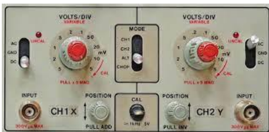
Slika 4: Kontrole sustava za vertikalni otklon analognog osciloskopa [3]
