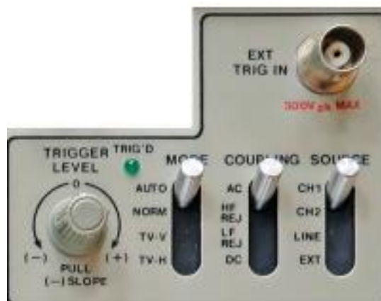
Slika 6:Okidni sustav analognog osciloskopa [3]
