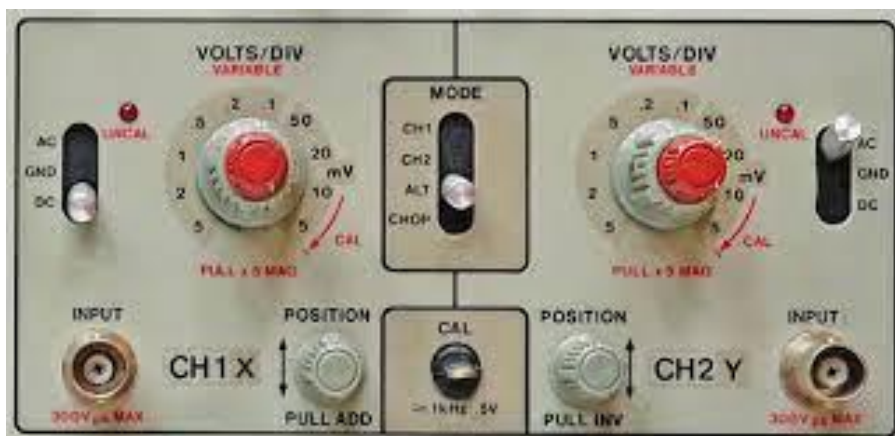
Slika 4: Kontrole sustava za vertikalni otklon analognog osciloskopa [3]
