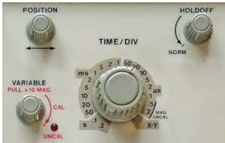
Slika 5:Kontrole sustava za horizontalni otklon analognog osciloskopa [3]
