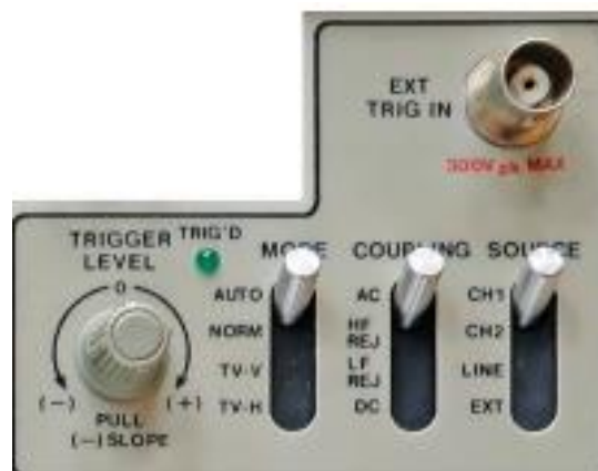
Slika 6:Okidni sustav analognog osciloskopa [3]
