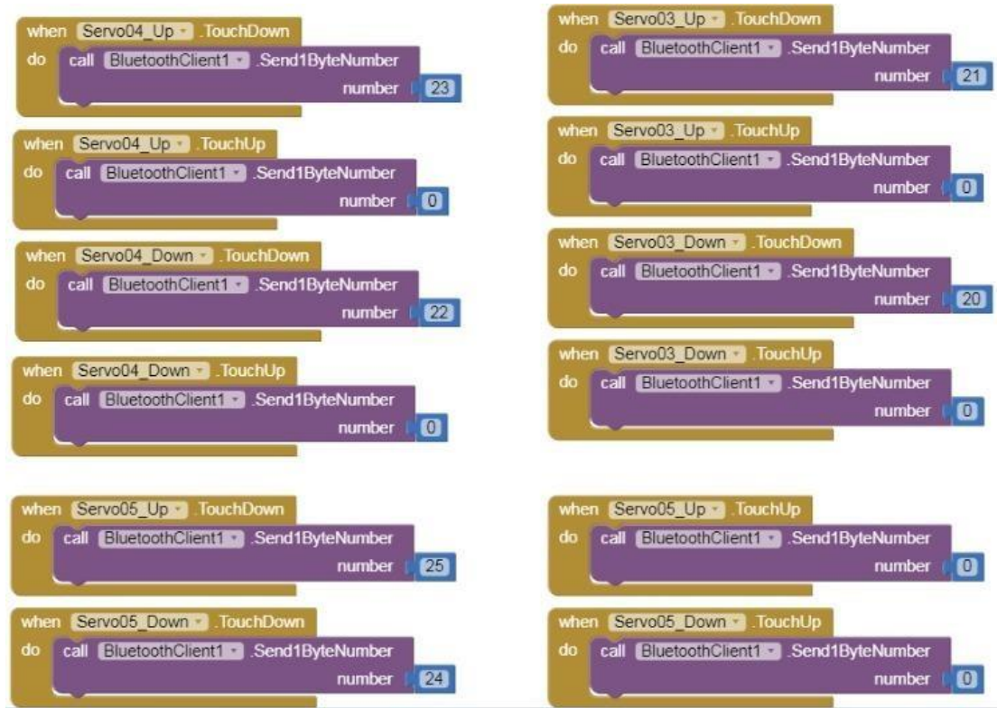
Slika 24: Blokovi za kontrolu servo motora
