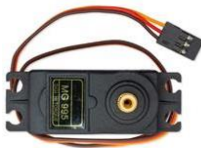
Slika 5: Servo motor TowerPro MG995
