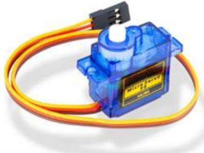
Slika 6: Servo motor TowerPro SG90
