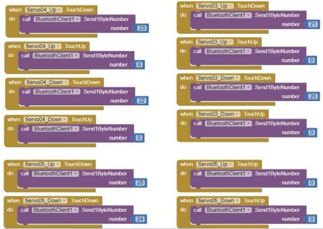
Slika 24: Blokovi za kontrolu servo motora
