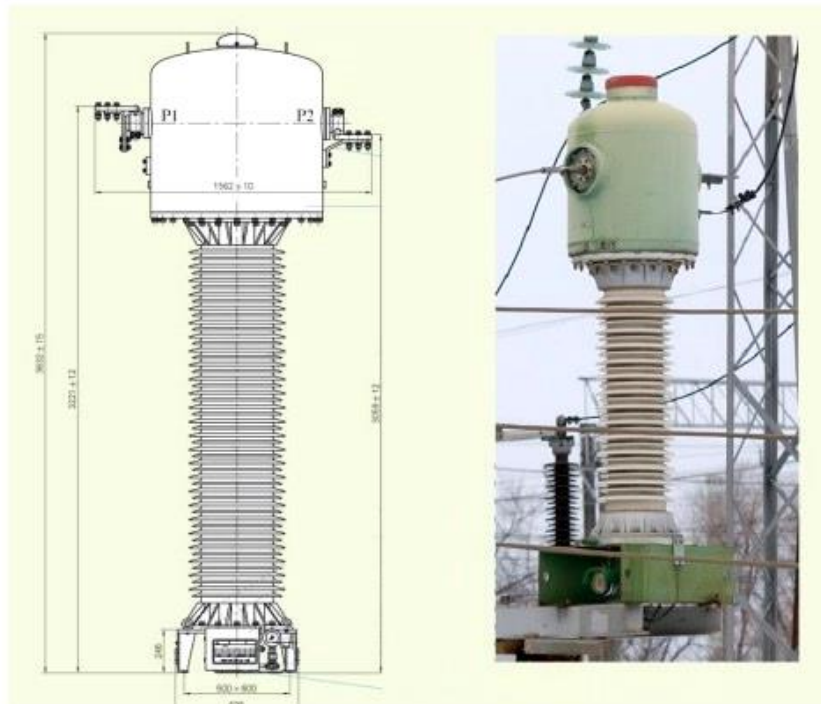
Slika 6. SF6 plinom izolirani ST, tip TGFM-110 [4]
