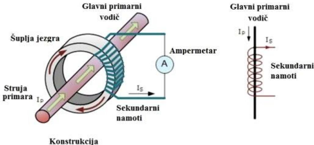
Slika 2. Mjerjenje struje kod provlačnog transformatora [4]
