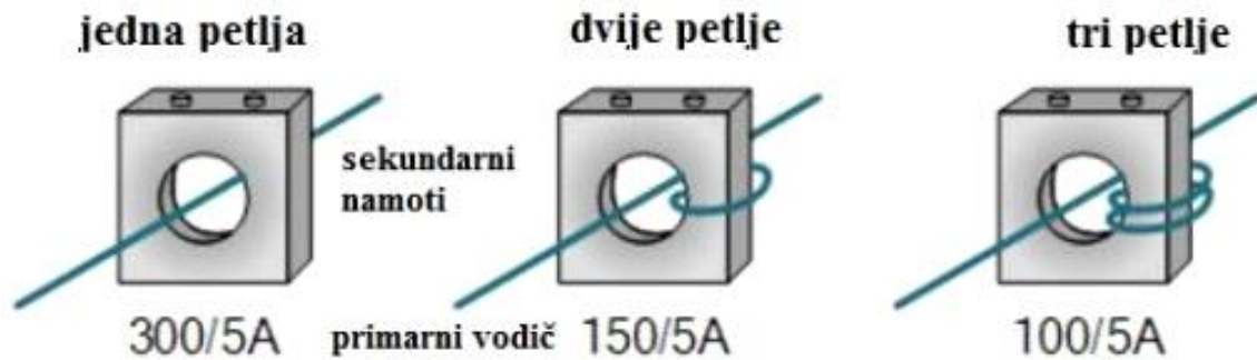
Slika 3. Namatanje dodatnih zavoja na sekundar [4]
