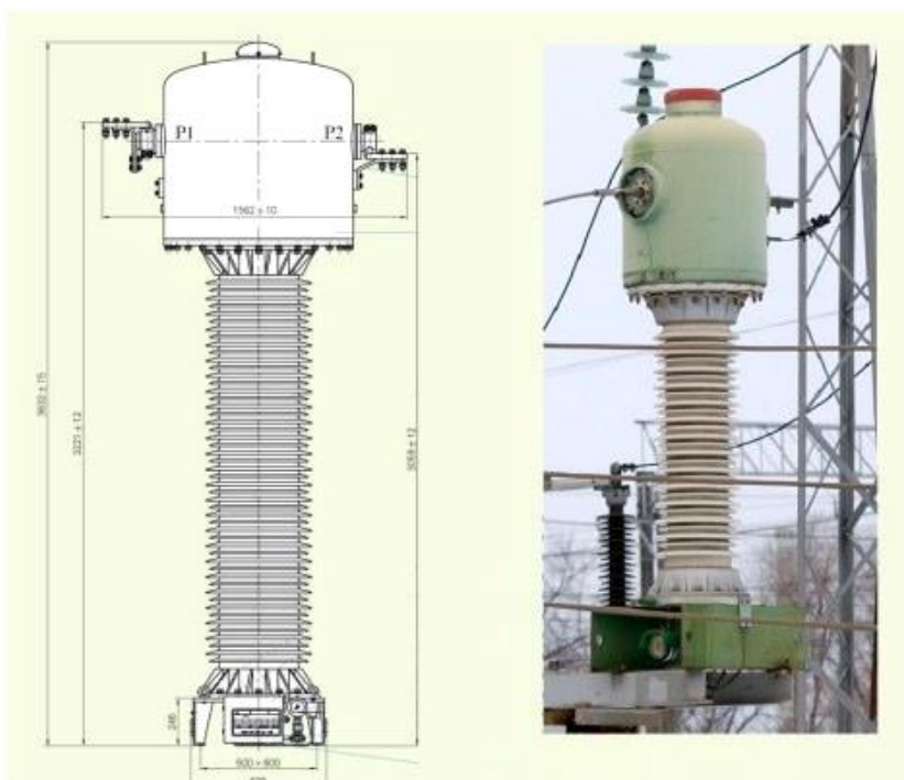
Slika 6. SF6 plinom izolirani ST, tip TGFM-110 [4]
