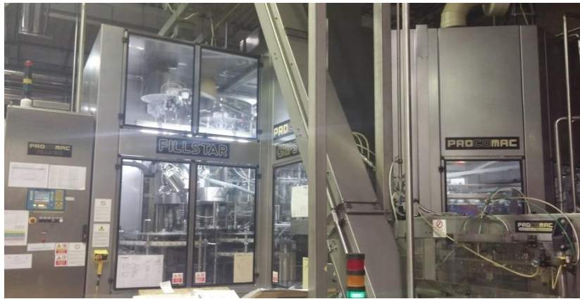
Slika 6.: Blok punjača-punjač, ispiralica i čepilica
