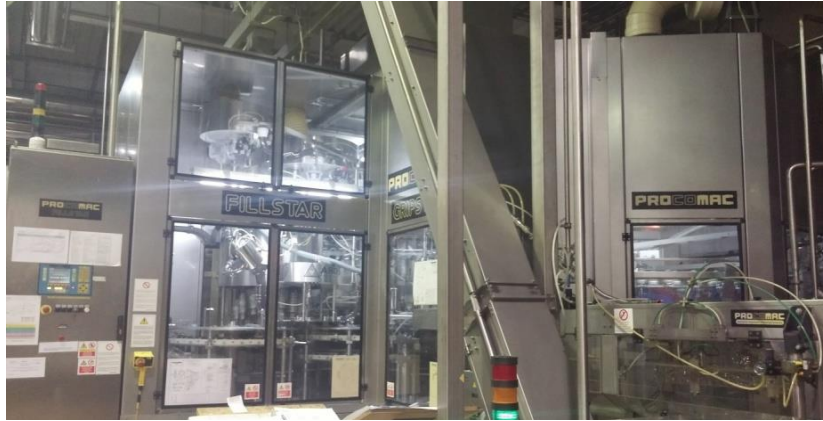
Slika 6.: Blok punjača-punjač, ispiralica i čepilica
