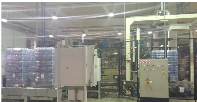
Slika 11.: Zaštitne mreže i znakovi upozorenja oko paletizatora
