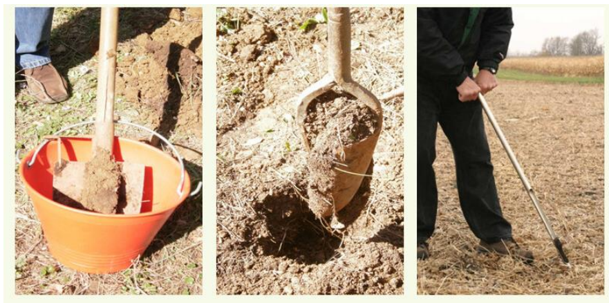
Slika 3: Načini uzimanja uzoraka tla pomoću sondi ili štijače
