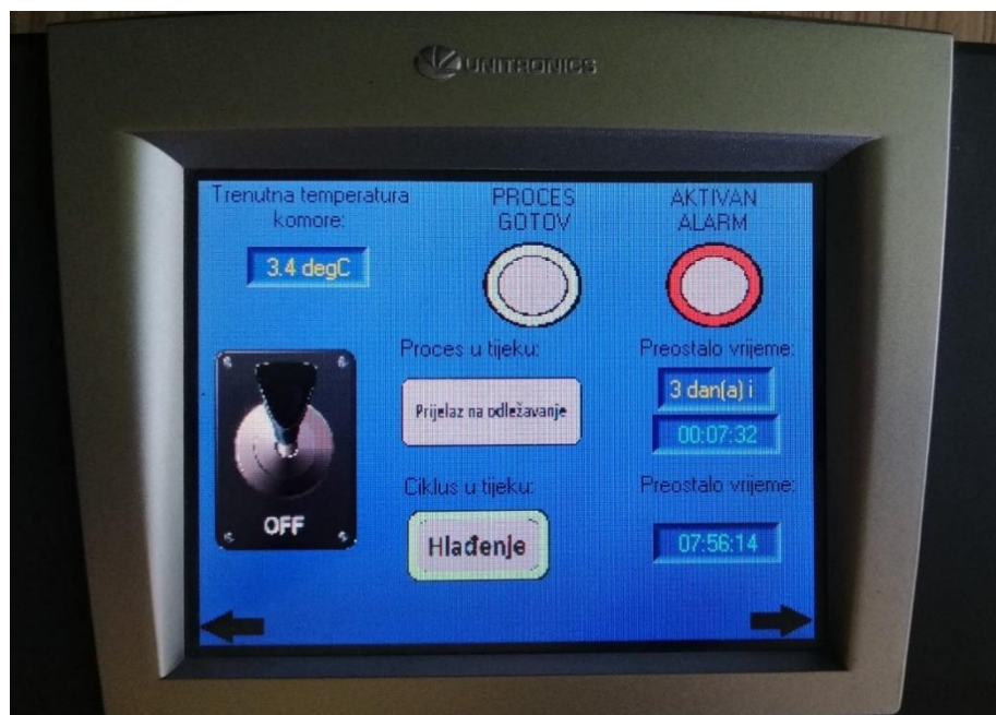
Slika 25: PLC - proces u tijeku: Prijelaz na odležavanje
