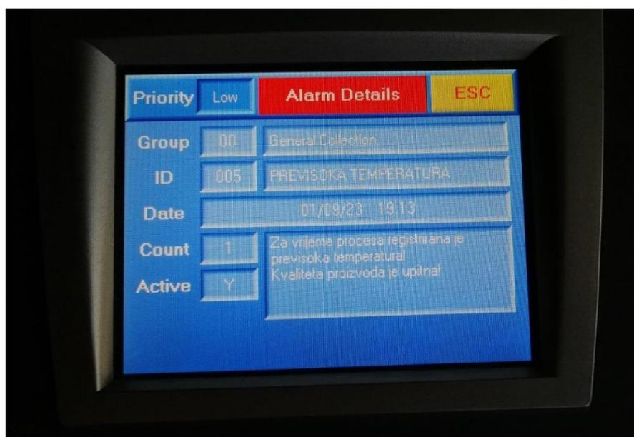
**Slika 32:** PLC - detalji alarma Previsoka temperatura
