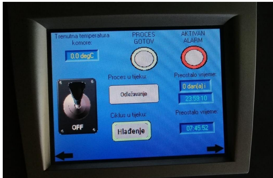
Slika 26: PLC - proces u tijeku: Odležavanje
