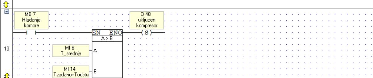
U modu rada 1 kada je srednja temperatura dosegla donju granicu histereze ( $T_{zadano} - T_{odstupanjeD}$ ) onda prestajemo s hlađenjem, odnosno gasimo kompresor i ventilatore
