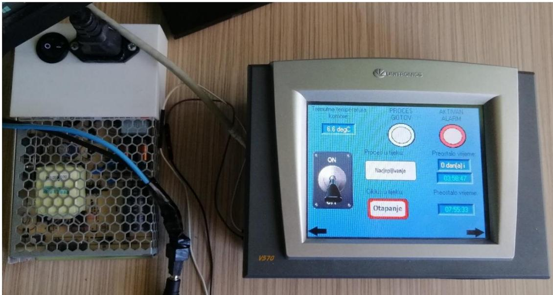
**Slika 17:** PLC (desno) i napajanje (lijevo)
