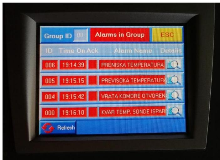
**Slika 31:** PLC - lista svih aktivnih alarma
