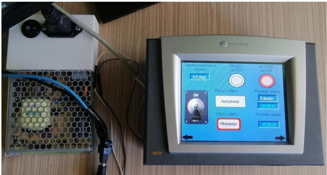
**Slika 17:** PLC (desno) i napajanje (lijevo)
