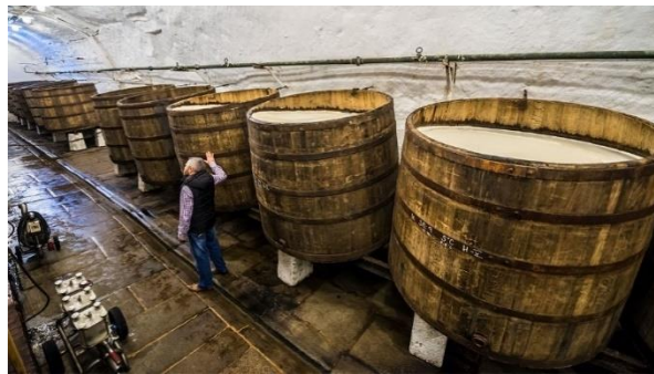
Slika 1: Otvorene fermentacijske posude u pivovari Pilsner Urquell u Pilsenu, Republika Češka
