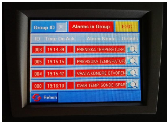
Slika 31: PLC - lista svih aktivnih alarma
