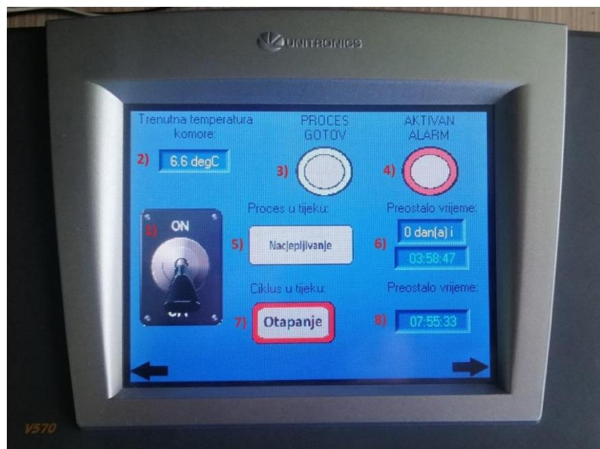
Slika 22: PLC - Opći prikaz, proces isključen
