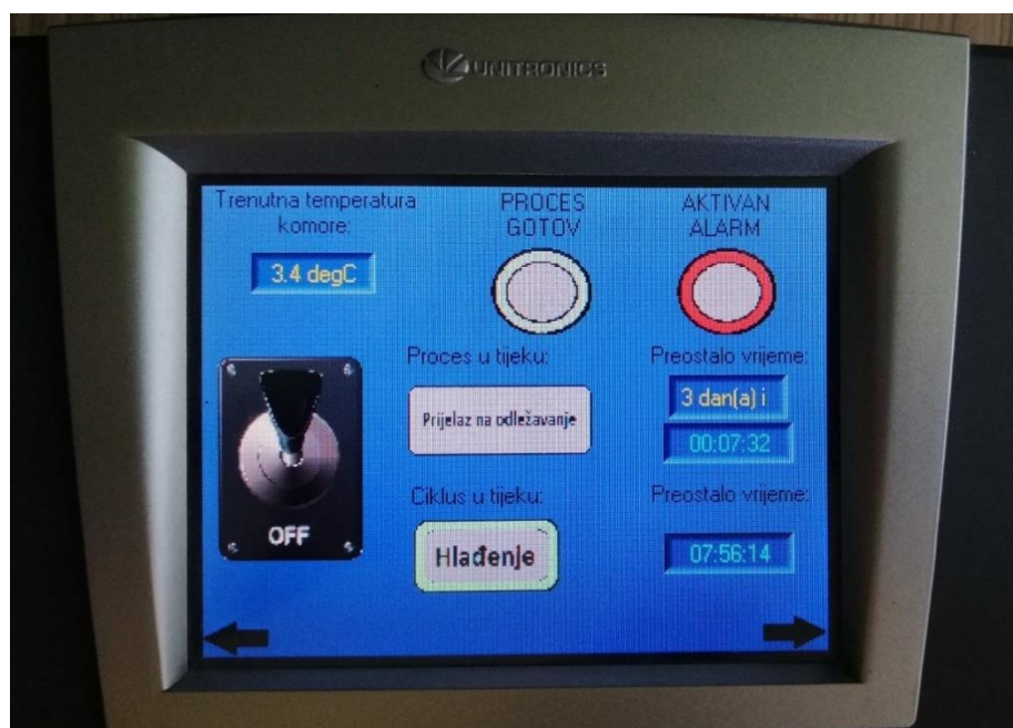
Slika 25: PLC - proces u tijeku: Prijelaz na odležavanje
