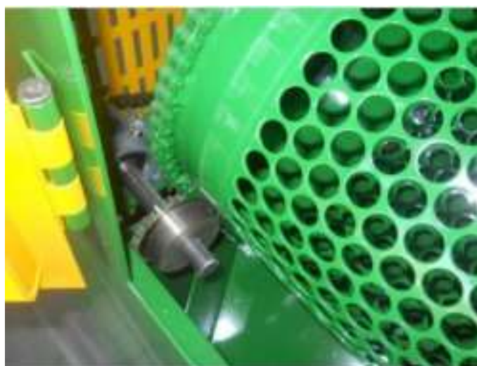
Slika 7. Limeni bubanj za urezanim profilima [4]
