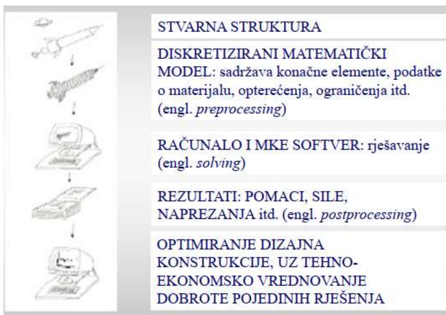
Slika 24. Proces projektiranja uporabom MKE [12]
