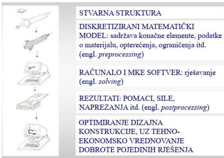
Slika 24. Proces projektiranja uporabom MKE [12]
