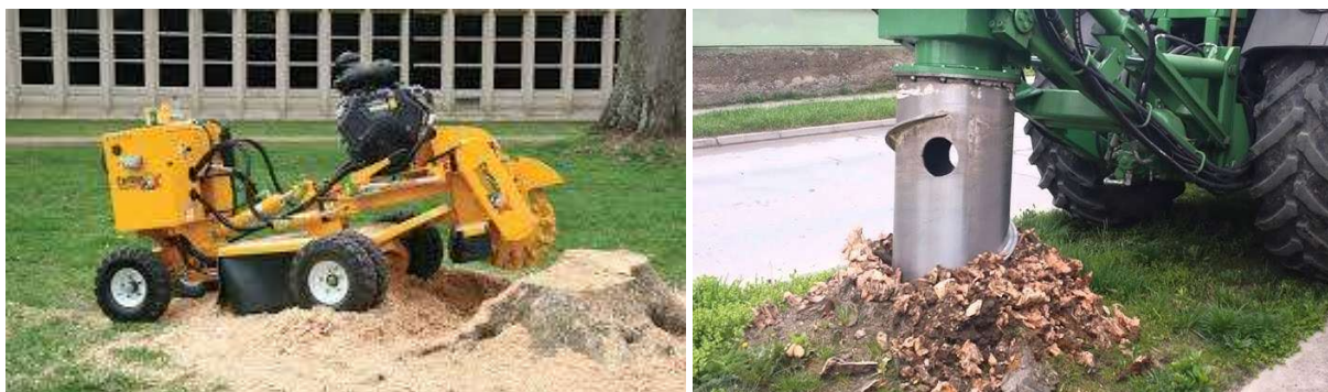
Slika 4. Slike drobilice (lijevo) i razvrtalica (desno) panjeva
