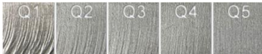
Slika 29. Različite hrapavosti površine nakon obrade vodenim mlazom [12]
