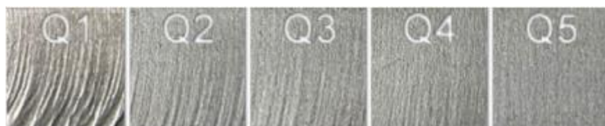
Slika 29. Različite hrapavosti površine nakon obrade vodenim mlazom [12]
