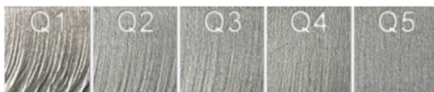
Slika 29. Različite hrapavosti površine nakon obrade vodenim mlazom [12]
