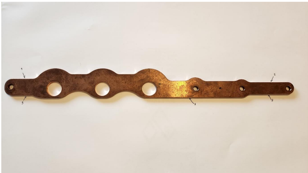
Slika 43. Bakreni izradak debljine 3 mm s točkama mjerenja
