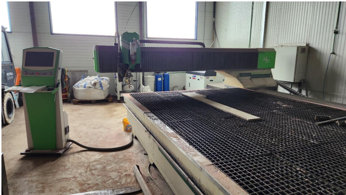
Slika 34. Radni stol, mlaznica i upravljačka jedinica
