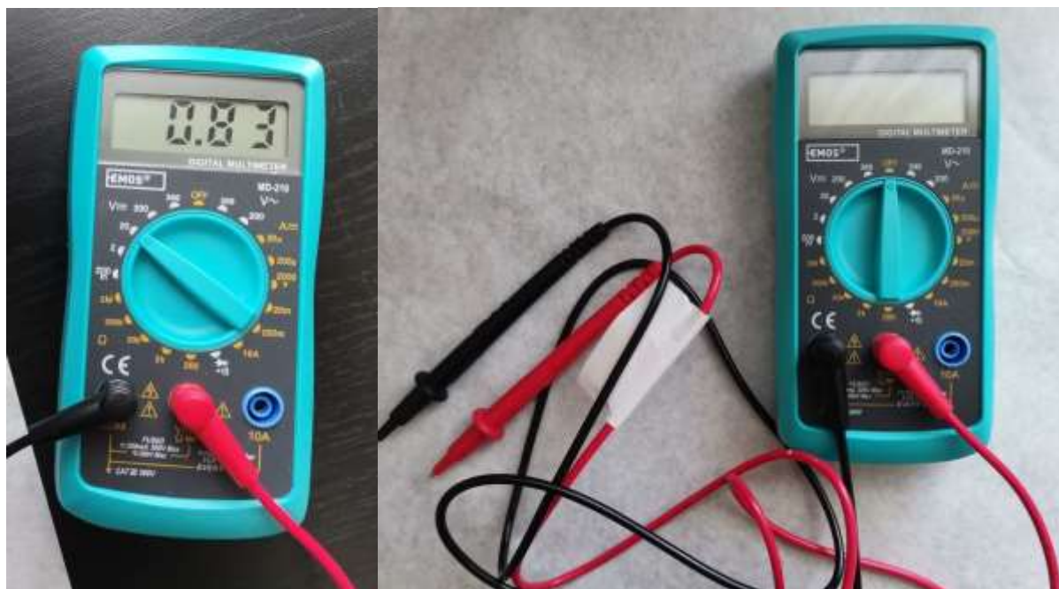
Slika 20. Digitalni multimetar (desno) i izmjereni napon na ćeliji (lijevo)
