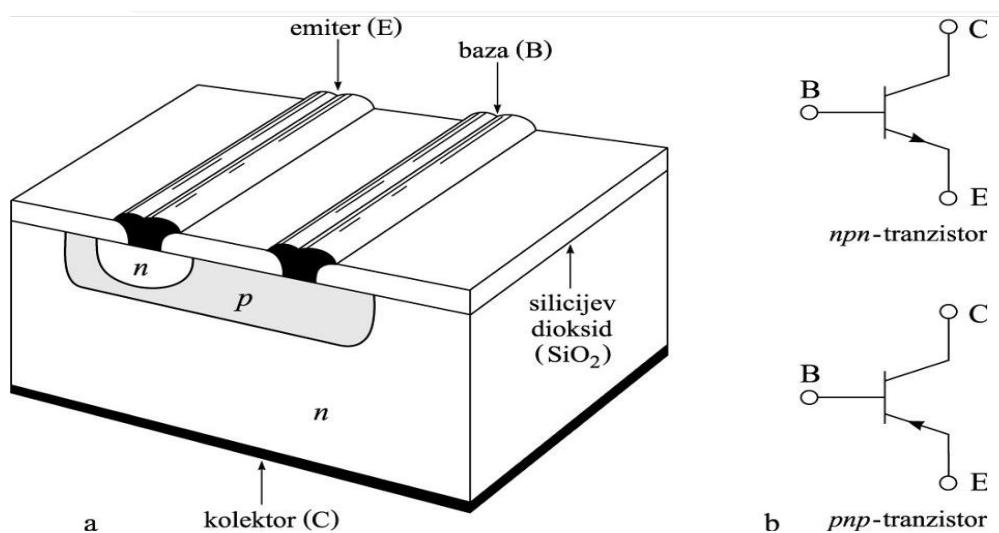
Slika 1. Predodžba presjeka NPN tranzistora
