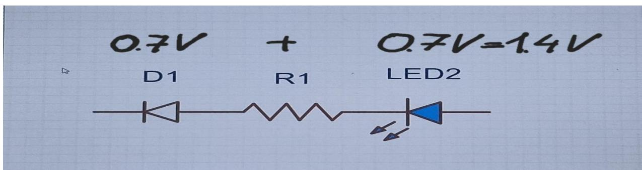
Slika 22. Predodžba jednog kanala LED vu metra
