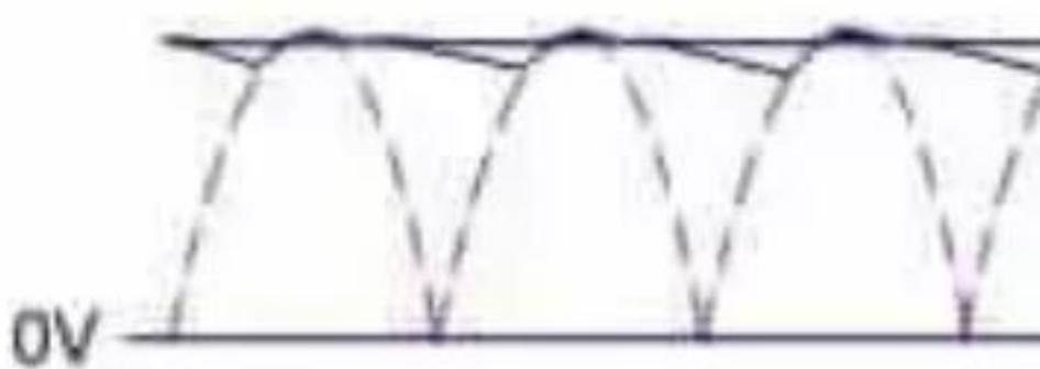
Slika 19. Predodžba "peglanja" signala pomoću kondenzatora
