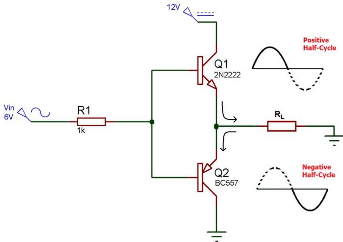
Slika 13. Predodžba "push-pull" konfiguracije tranzistora
