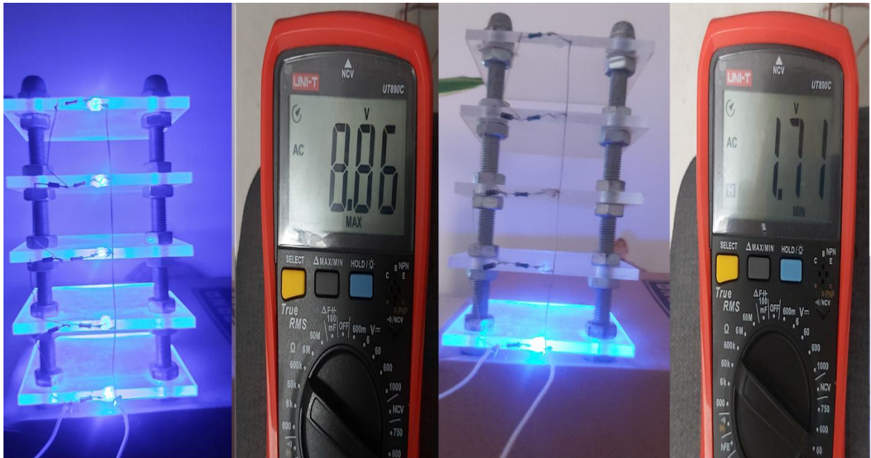
Slika 23. Predodžba ovisnosti izlaznog napona o broju upaljenih LED dioda
