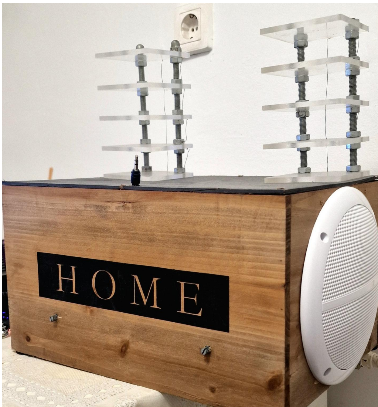
Slika 34. Predodžba završnog izgleda pojačala sa LED vu metrom
