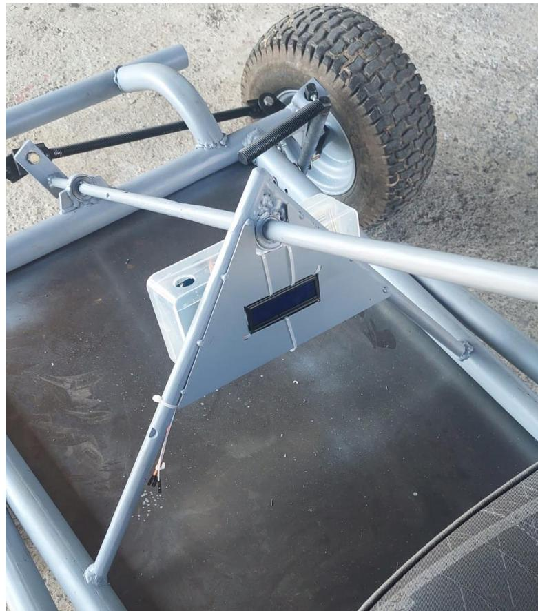
Slika 36 Postavljen sustav za mjerjenje brzine [Izvorno autor]
