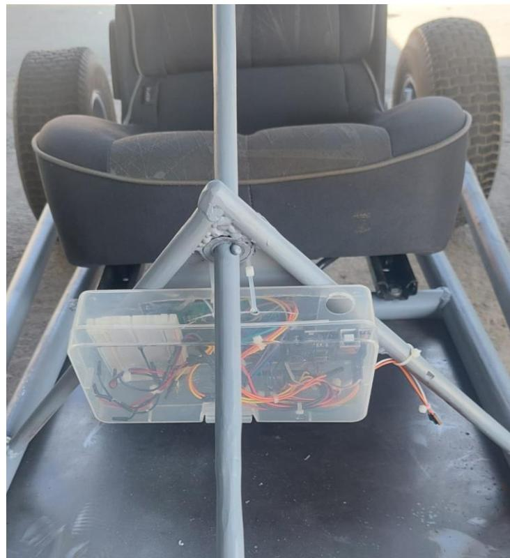
Slika 35 Postavljen sustav za mjerjenje brzine [Izvorno autor]
