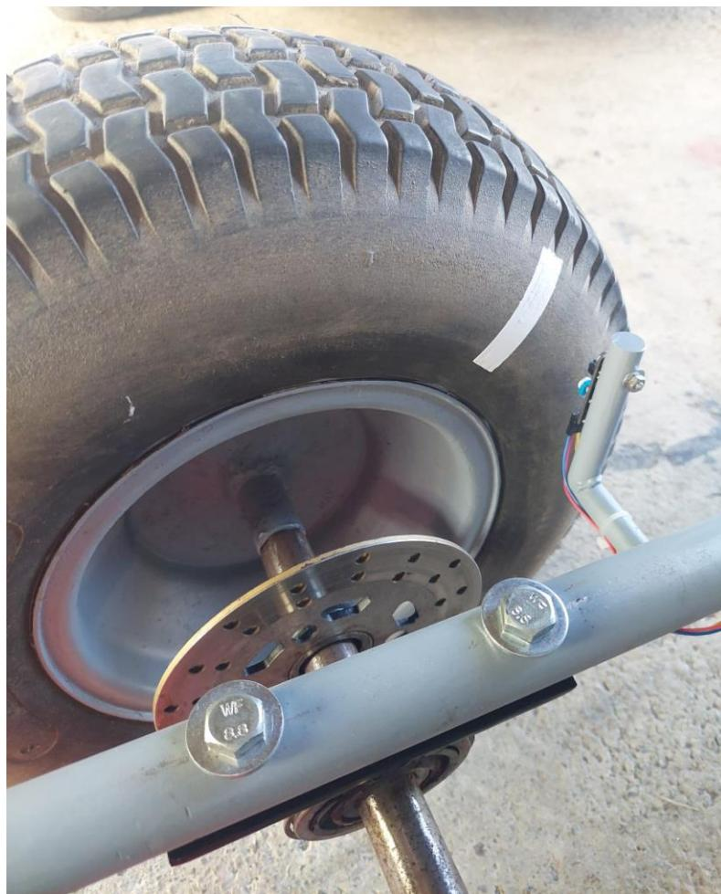
Slika 32 Postavljen IR senzor [Izvorno autor]
