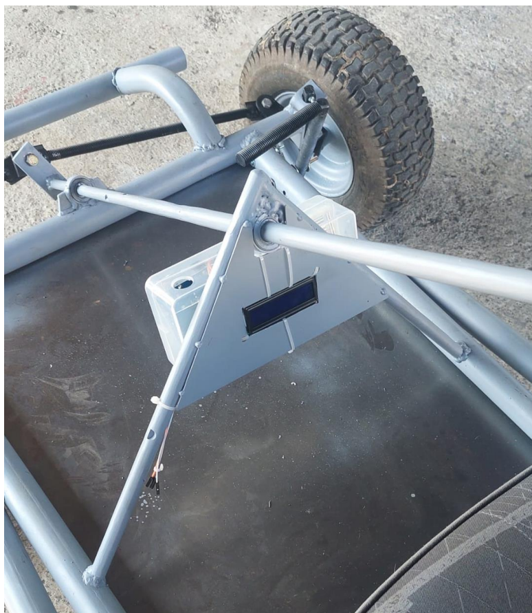
Slika 36 Postavljen sustav za mjerenje brzine [Izvorno autor]
