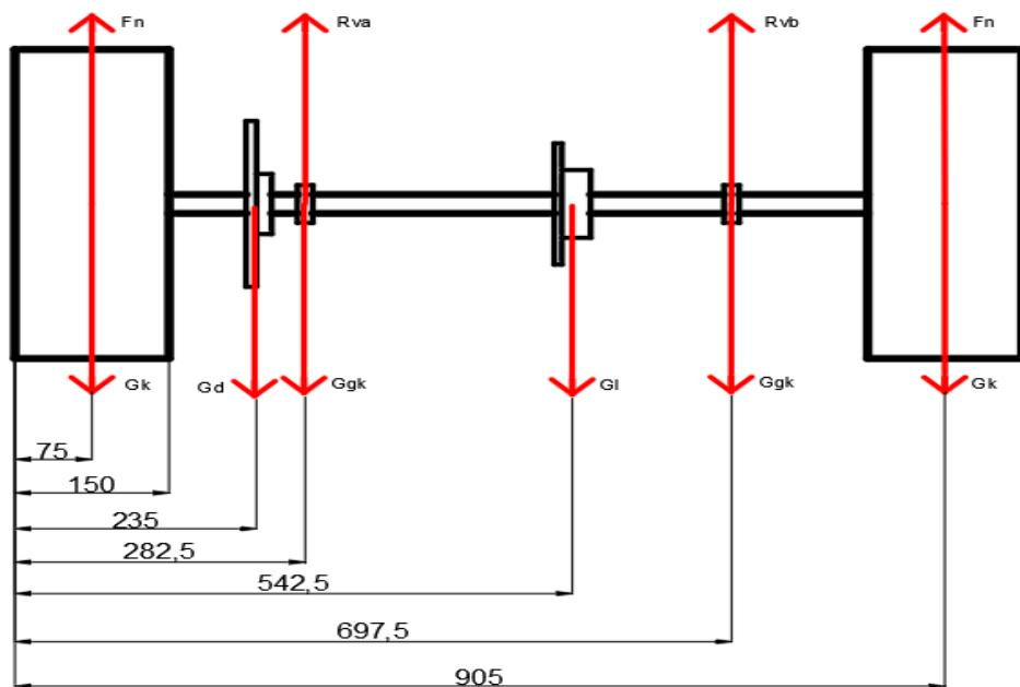
Slika 6 Skica vertikalnih sila vratila [Izvorno autor]
