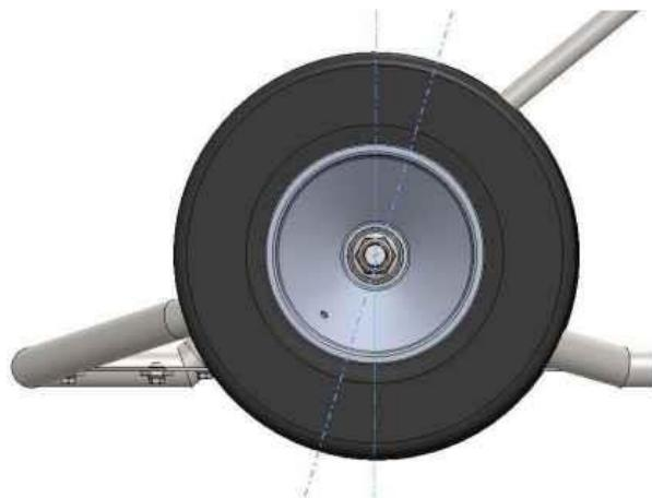
Slika 26 Uzdužni nagib osi zakreta kotača [23]
