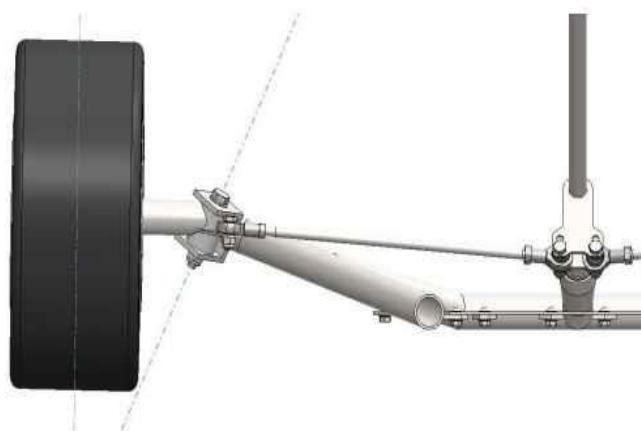
Slika 27 Bočni nagib osi zakreta kotača [24]
