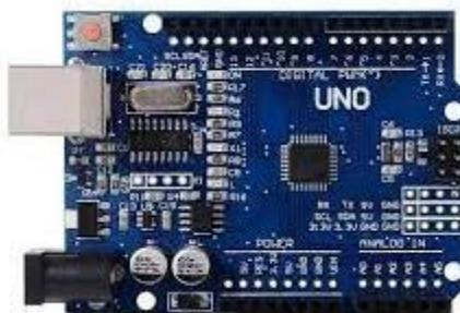
Slika 29 Mikrokontrolerska pločica Arduino UNO [23]
