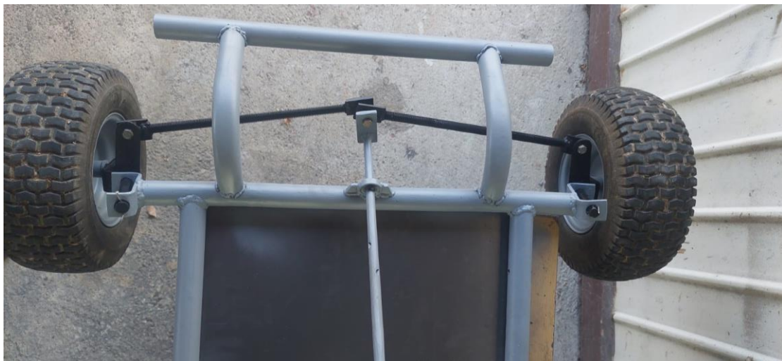
Slika 19 Povezana pločica i šipke [Izvorno autor]
