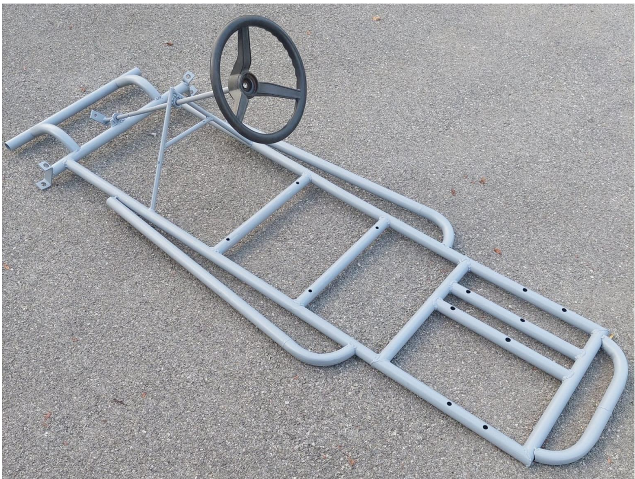
Slika 13 Predodžba izrađene šasije od bešavnih cijevi [Izvorno autor]
