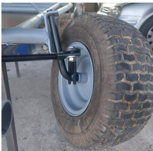
Slika 28 Ackermannov princip skretanja [Izvorno autor]
