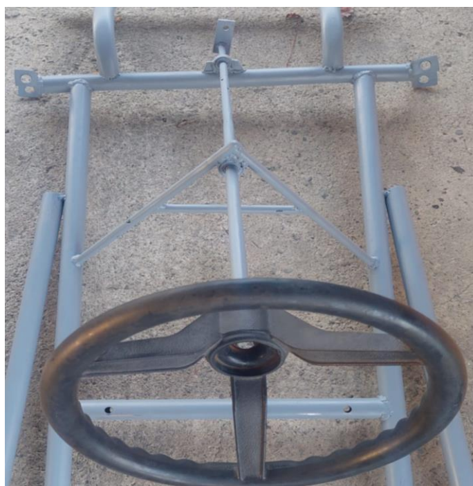
Slika 17 Nosač volana [Izvorno autor]
