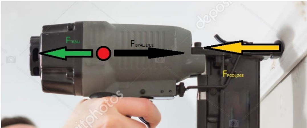
Slika 7 Skica sila pri korištenju zabijača čavala na uređaju [7]
