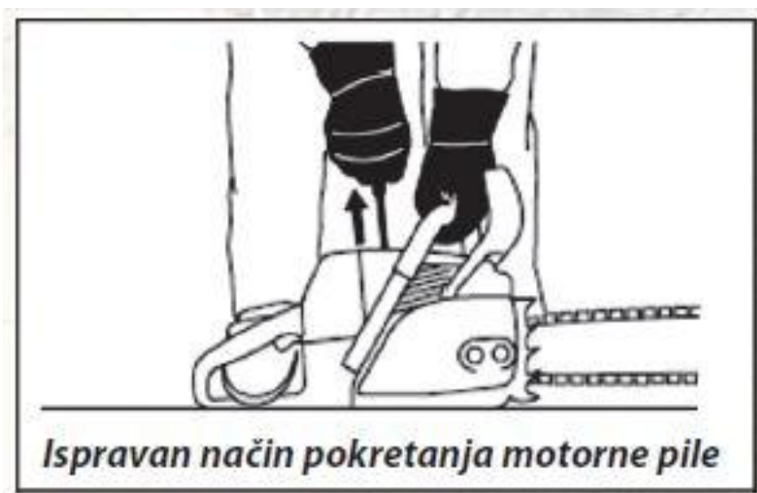
Slika 5. – Ispravan način pokretanja motorne pile
