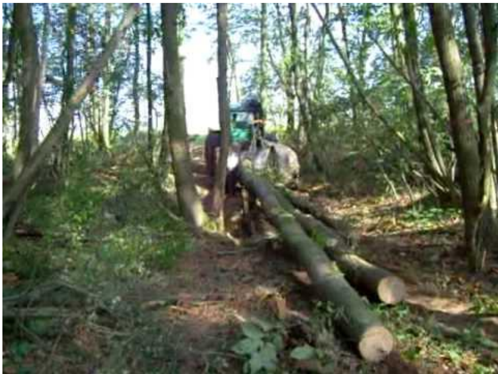
Slika 20. – Izvlačenje trupaca do sabirališta
