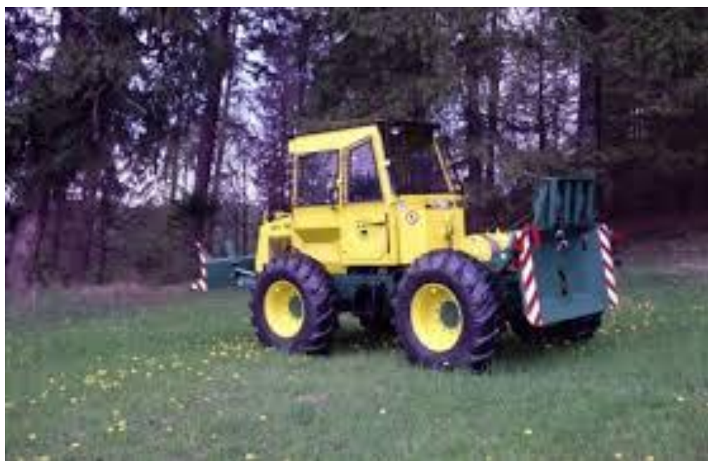
Slika 17. – Šumski zglobni traktor
