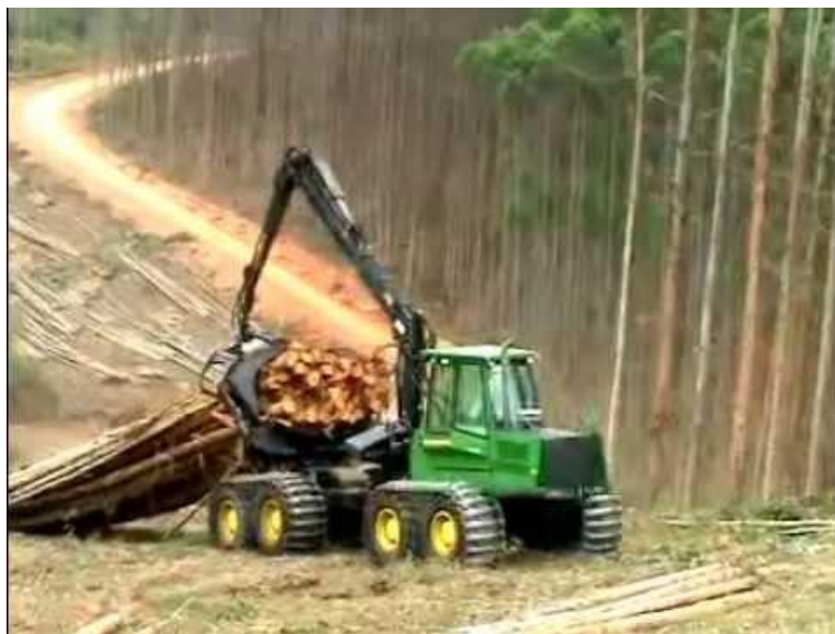
Slika 23. – Traktor clum – bank skidder
