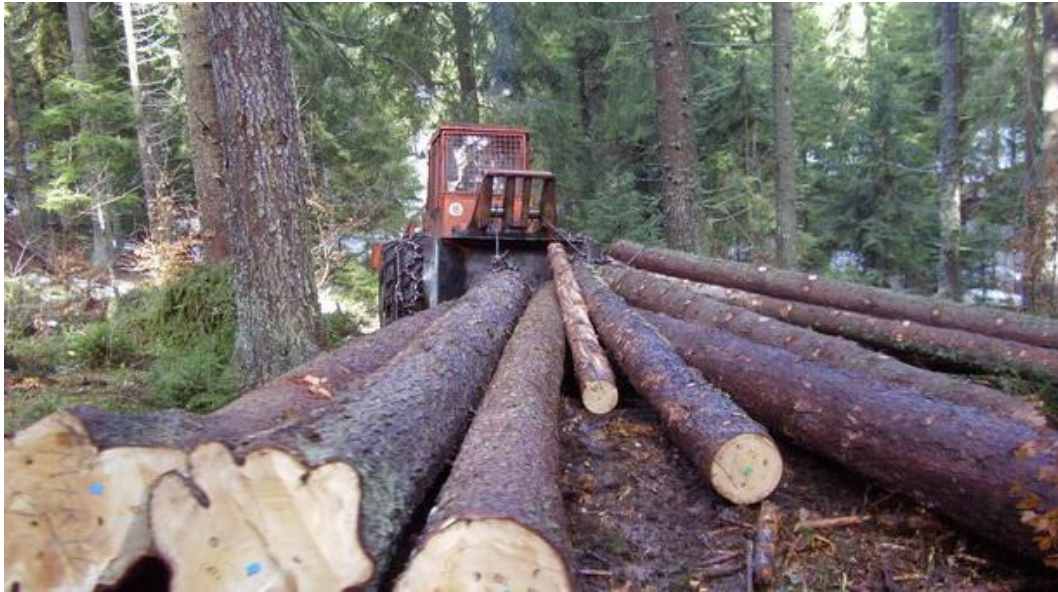
Slika 19. – Privlačenje sortimenata pomoću šumskog traktora
