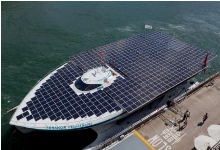
Slika 3.1. Solarno vozilo katamaran Planet Solar ( Turanor ); najveći današnji brod na solarni pogon
