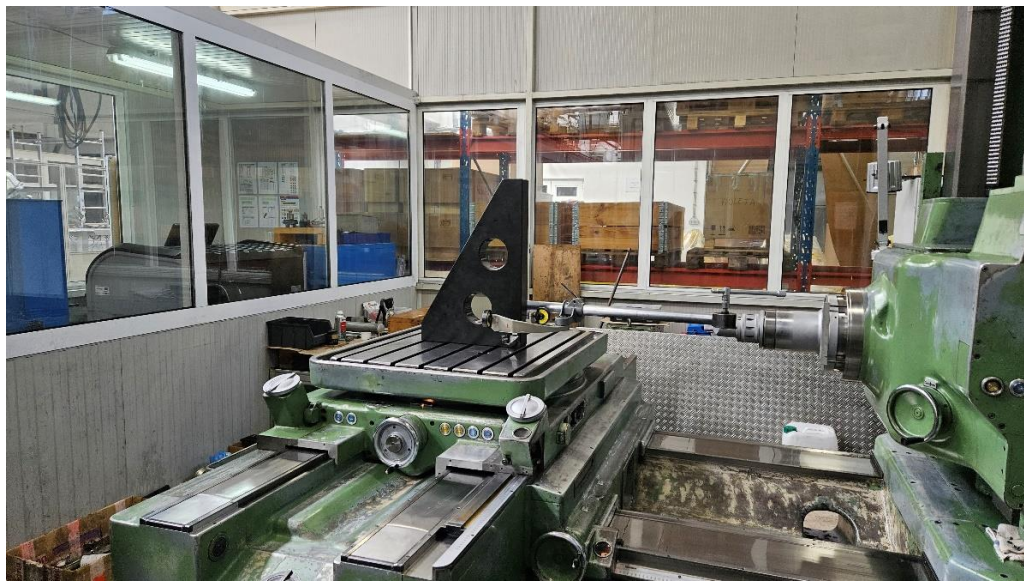
Slika 47. Mjerenje pravokutnosti stola prema okomitim kliznim stazama[Autor]
