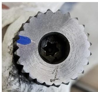
Slika 10. Trapezni vijak sa zazubljenom glavom[Autor]
