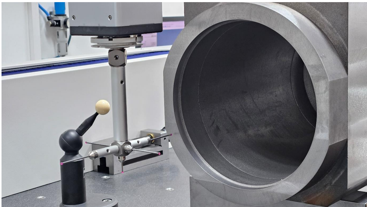
Slika 55. Završna kontrola testnog obratka[Autor]
