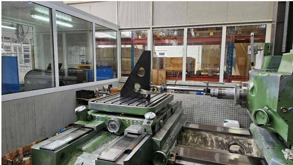
Slika 47. Mjerenje pravokutnosti stola prema okomitim kliznim stazama[Autor]
