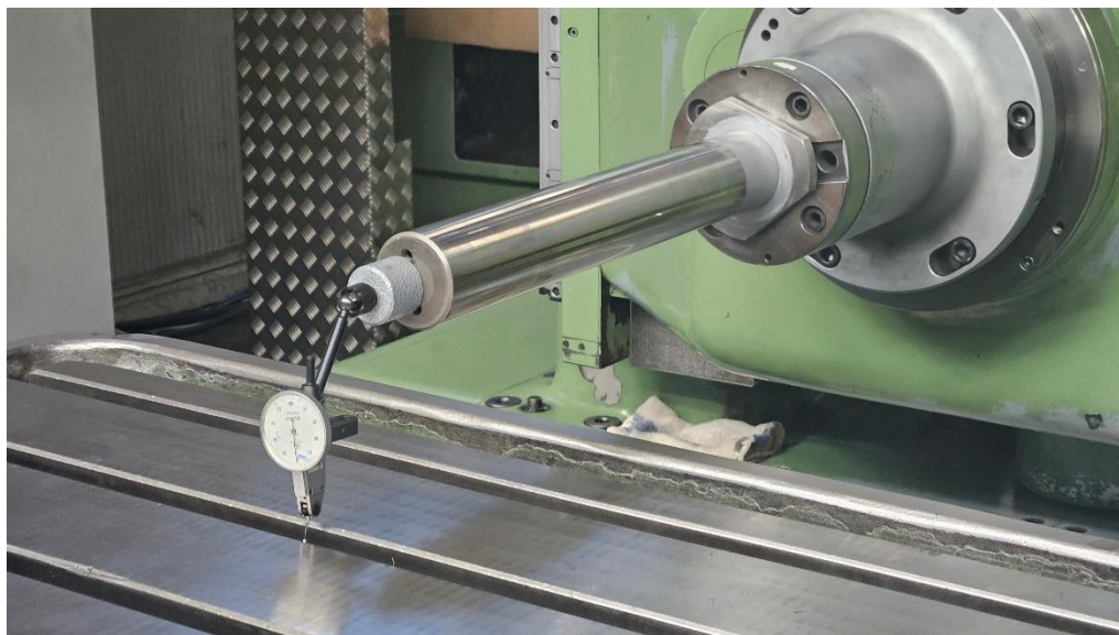
Slika 45. Mjerenje paralelnosti stola s kliznim stazama[Autor]
