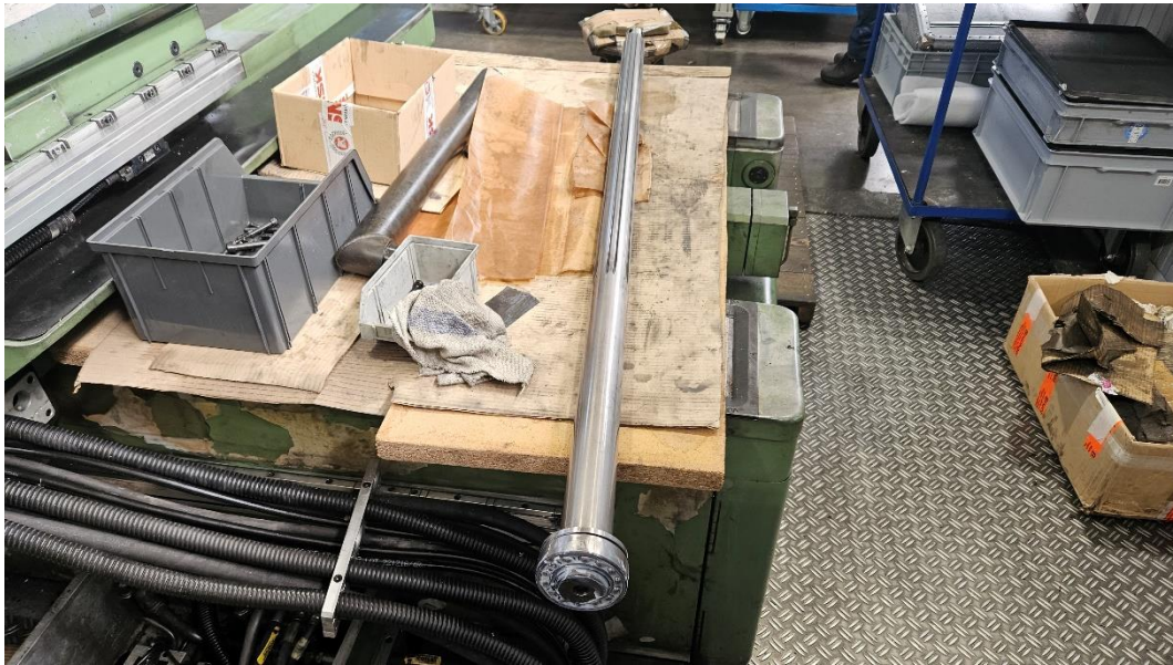
Slika 21. Vreteno za pokretanje pinole[Autor]
