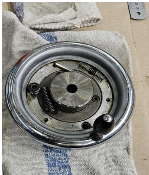
Slika 14. Ručica za fino pozicioniranje[Autor]
