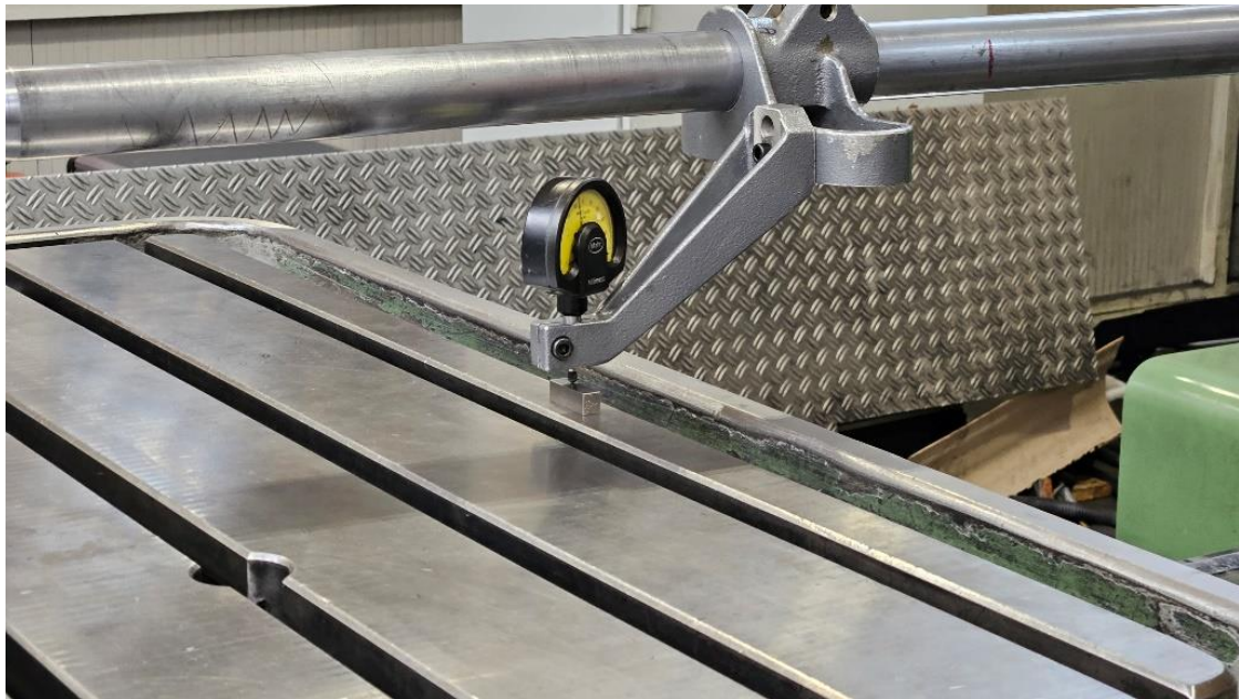
Slika 41. Ispitivanje paralelnosti površine s kliznim stazama stola[Autor]
