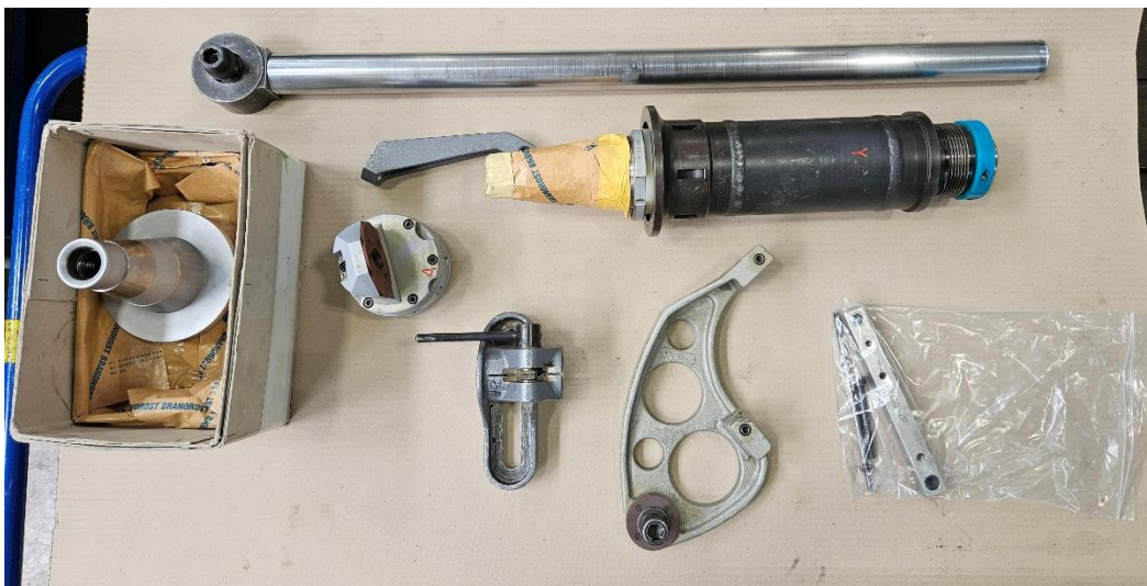
Slika 40. Alat za geometriju stroja[Autor]
