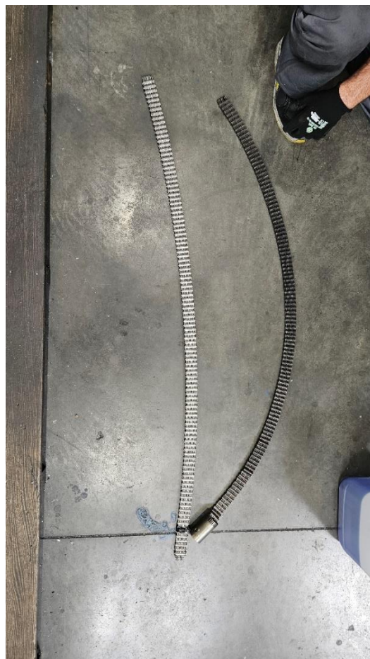
Slika 36. Novi i stari lanac[Autor]
