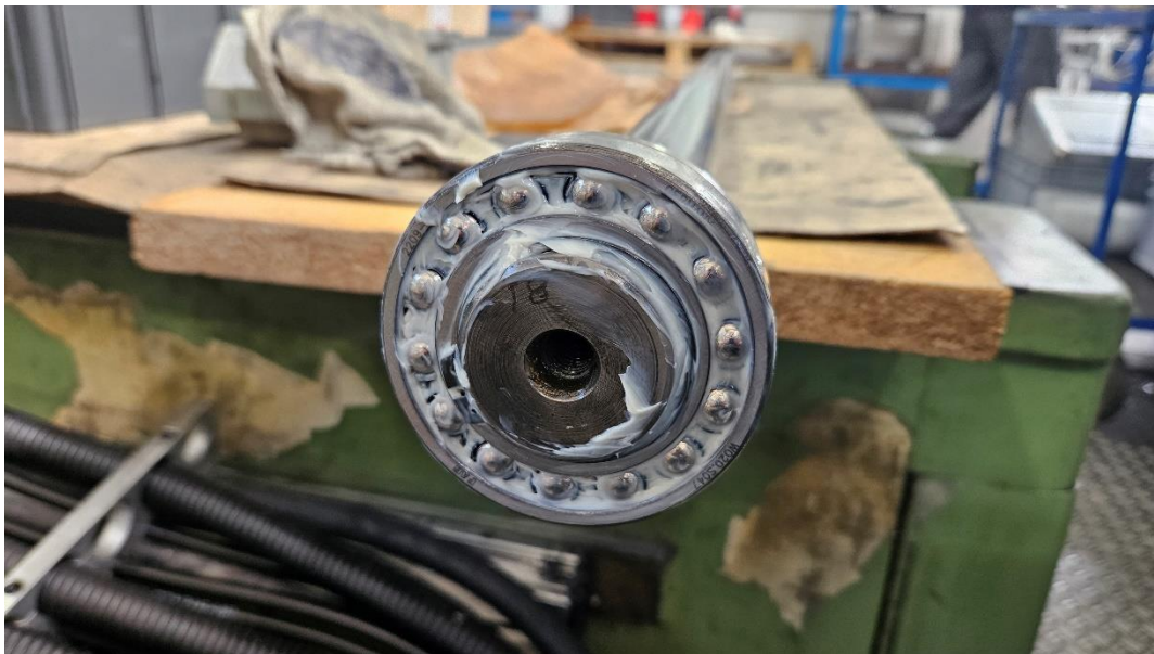
Slika 22. Novi kuglični ležaj vretena[Autor]
