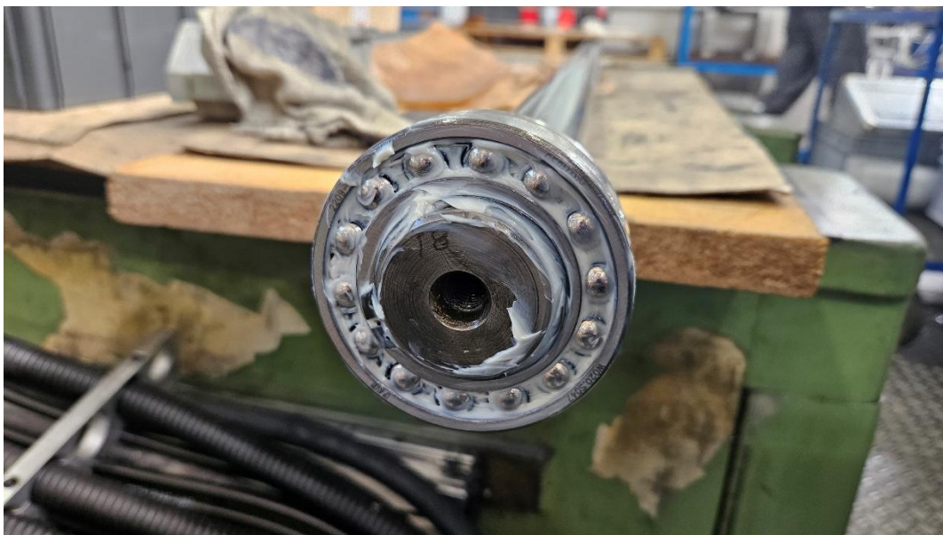
Slika 22. Novi kuglični ležaj vretena[Autor]
