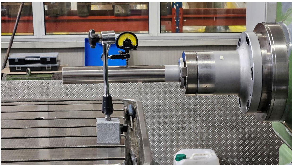
Slika 48. Mjerenje ravnosti stupova[Autor]
