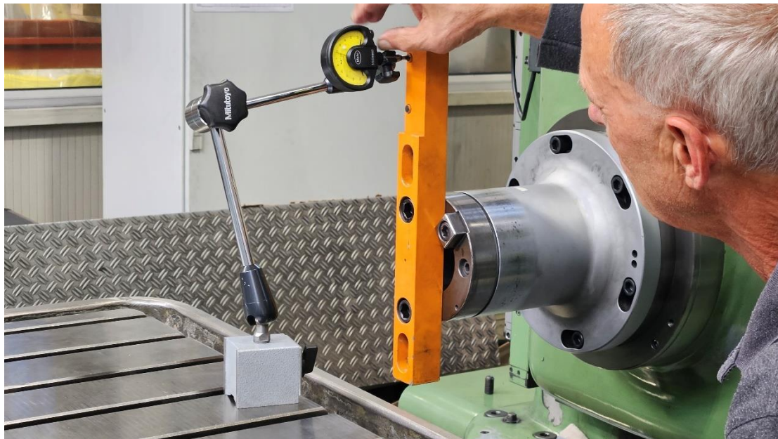
Slika 49. Mjerenje pravokutnosti vretena[Autor]
