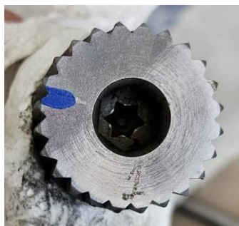
Slika 10. Trapezni vijak sa zazubljenom glavom[Autor]
