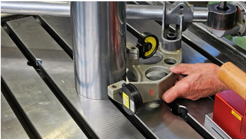
Slika 46. Mjerenje ravnosti kliznih staza[Autor]
