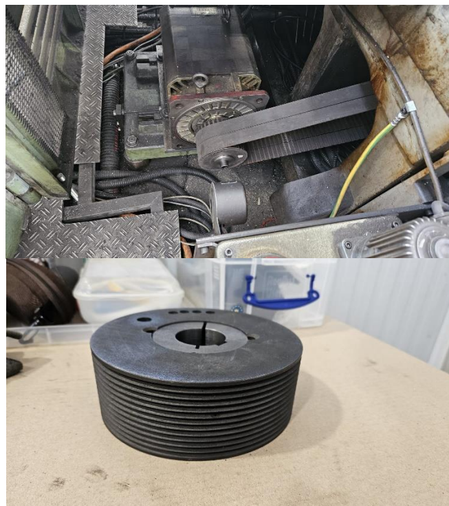
Slika 20. Elektromotor i nova remenica[Autor]
