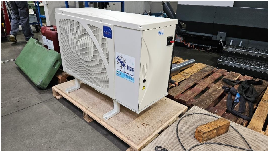
Slika 29. Dodatna unutarnja jedinica za hlađenje ulja[Autor]
