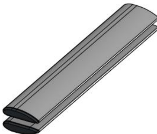
Slika 1.5 Preklopni krovni nosač u sklopljenom stanju
