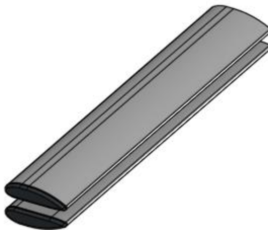
Slika 1.5 Preklopni krovni nosač u sklopljenom stanju
