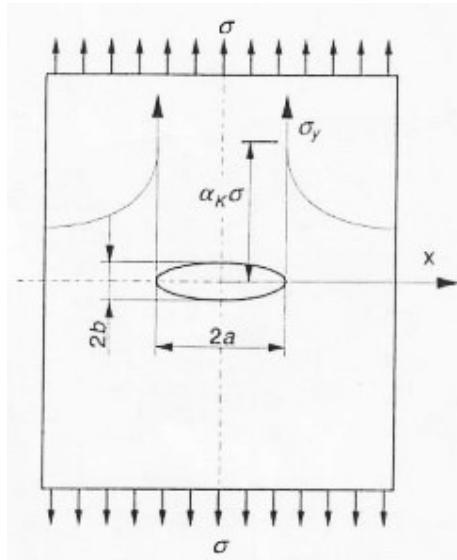
Slika 34. Koncentracija naprezanja oko eliptičnog otvora. [14]
