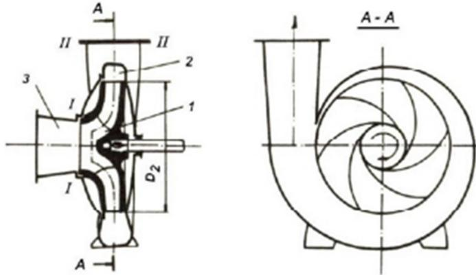
Slika 7. Radijalna pumpa – presjek. [1]
