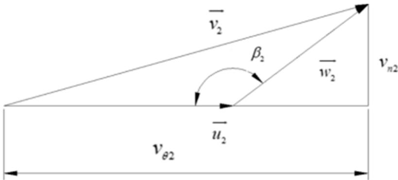
Slika 6. Trokut brzina na izlazu iz rotora. [4]
