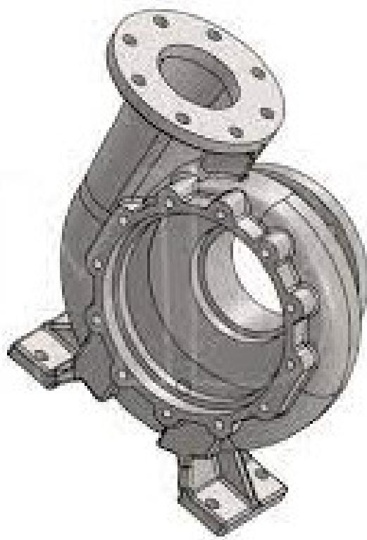
Slika 13. Spiralno kućište. [9]
