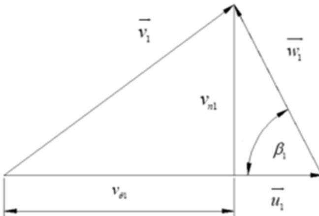
Slika 5. Trokut brzina na ulazu u rotor. [4]
