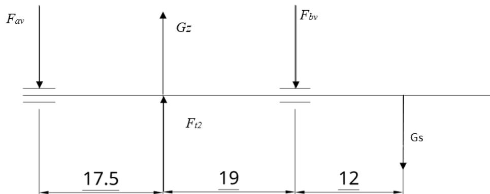
Slika 18. Dijagram opterećenja vratila u vertikalnoj ravnini.
