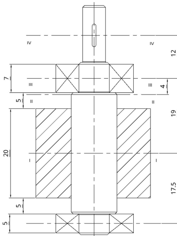
**Slika 19. Prikaz momenta savijanja u određenom presjeku.**
