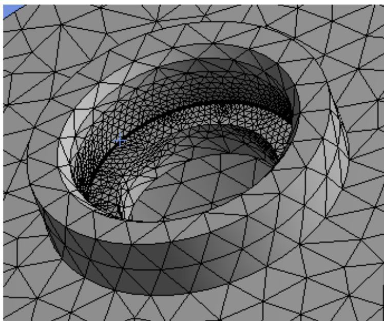
Slika 34. Promjena veličine konačnih elemenata u području očekivanog najvećeg naprezanja.
