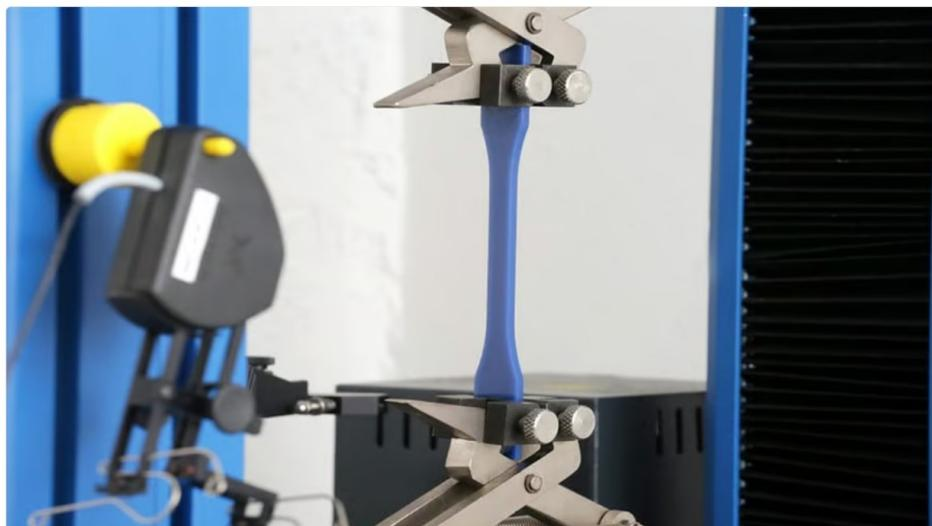
Slika 39. Prikaz ispitne epruvete na kidalici [11].
