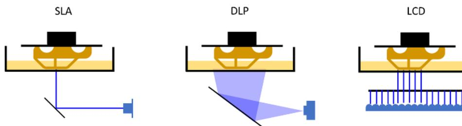
Slika 9. Princip rada različitih printera na smolu [29].
