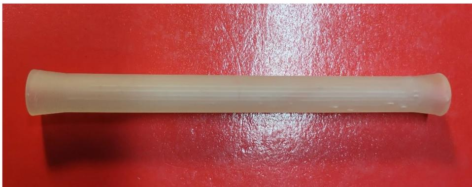
Slika 46. Isprintana epruveta
