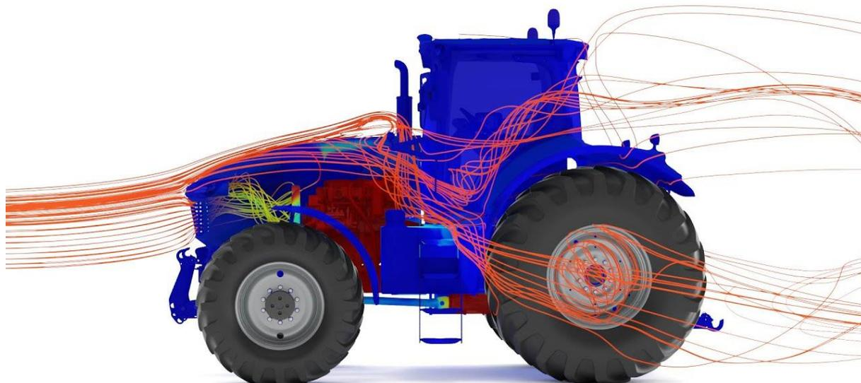
**Slika 16.** Primjer simulacije strujanja zraka kod modernog traktora [7]
