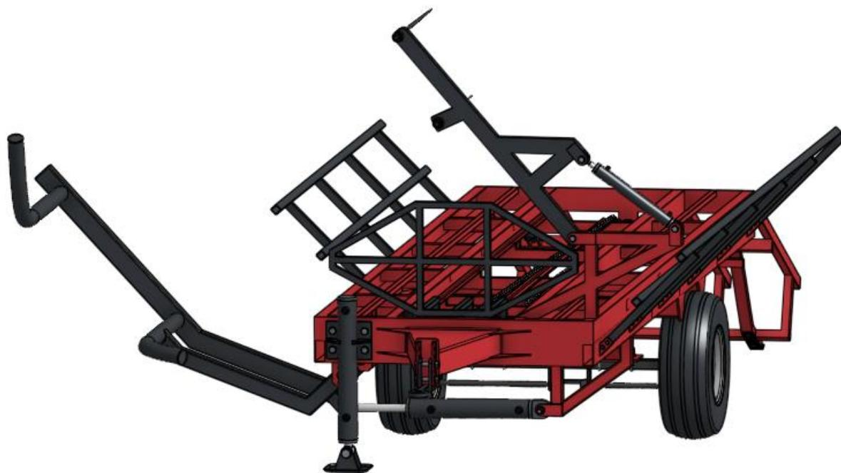
**Slika 37.** Prikaz principa podizanja bala
