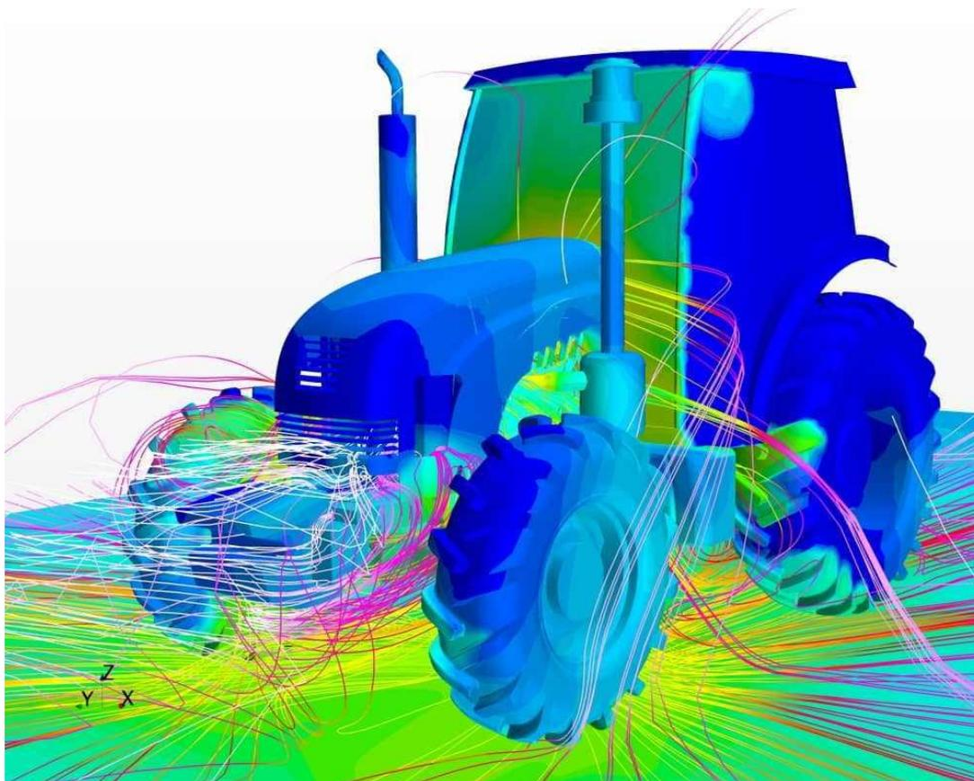
**Slika 17.** Primjer strujanja zraka kod YTO traktora [10]
