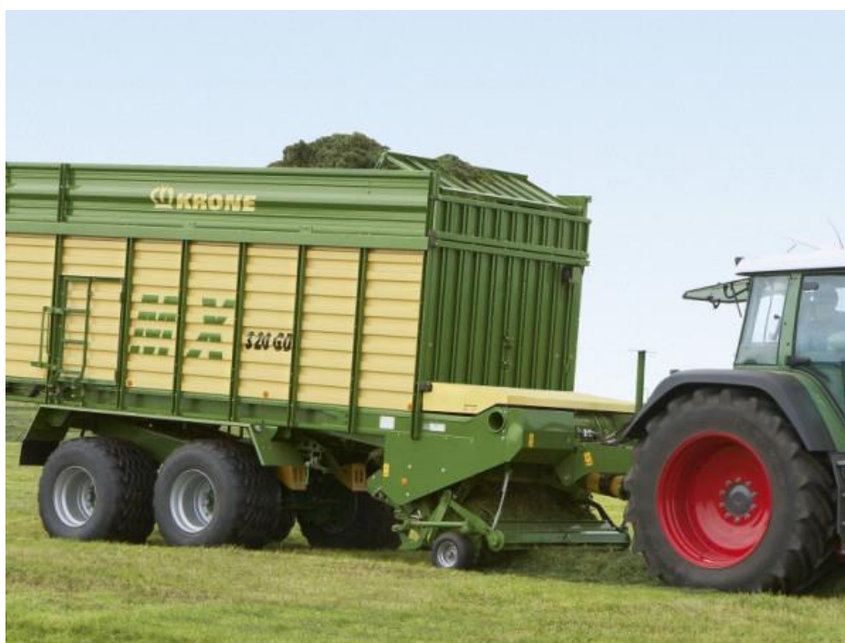
Slika 3. Primjer samo utovarne prikolice za rastresit teret [18]
