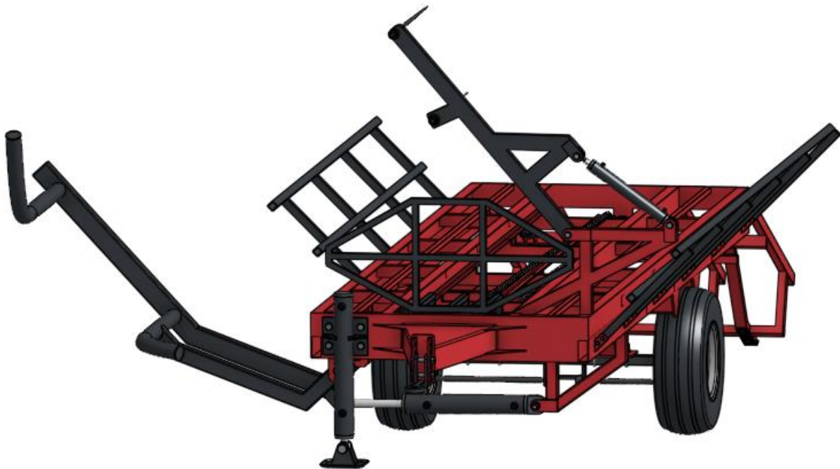
Slika 36. Princip istovara tereta preko stražnje rampe
