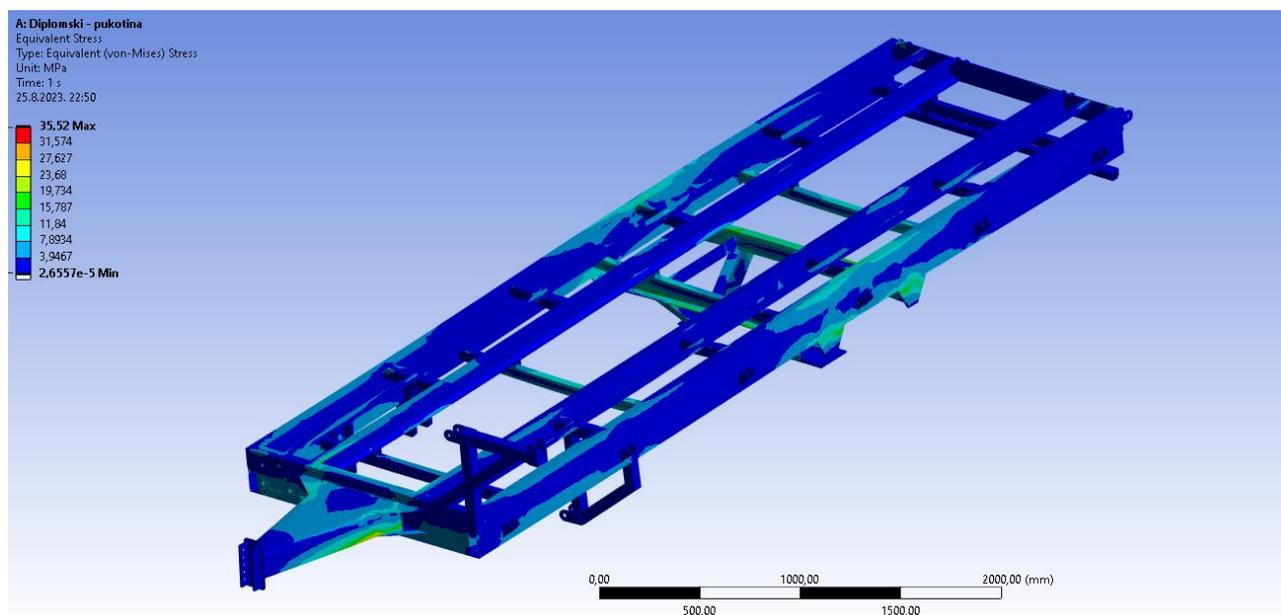
Slika 27. Raspored naprezanja maksimalno iznosi 35,5 MPa
