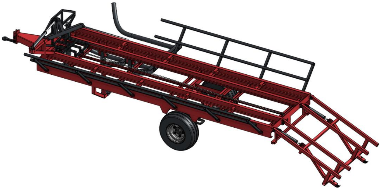
Slika 36. Princip istovara tereta preko stražnje rampe
