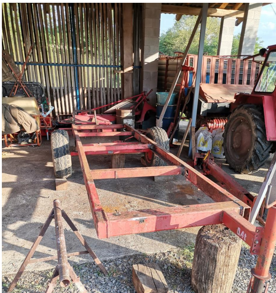
Slika 14. Šasija prikolice nakon uklanjanja svega nepotrebnog
