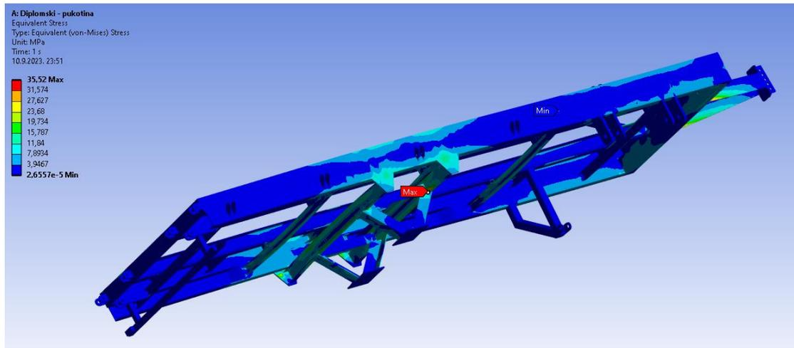
Slika 28. Detaljniji prikaz maksimalnog naprežanja na zavarenom spoju
