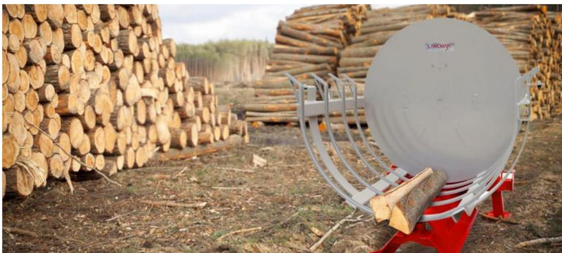
**Slika 9.** Princip sastavljanja okruglih bala ogrjevnog drva [16]
