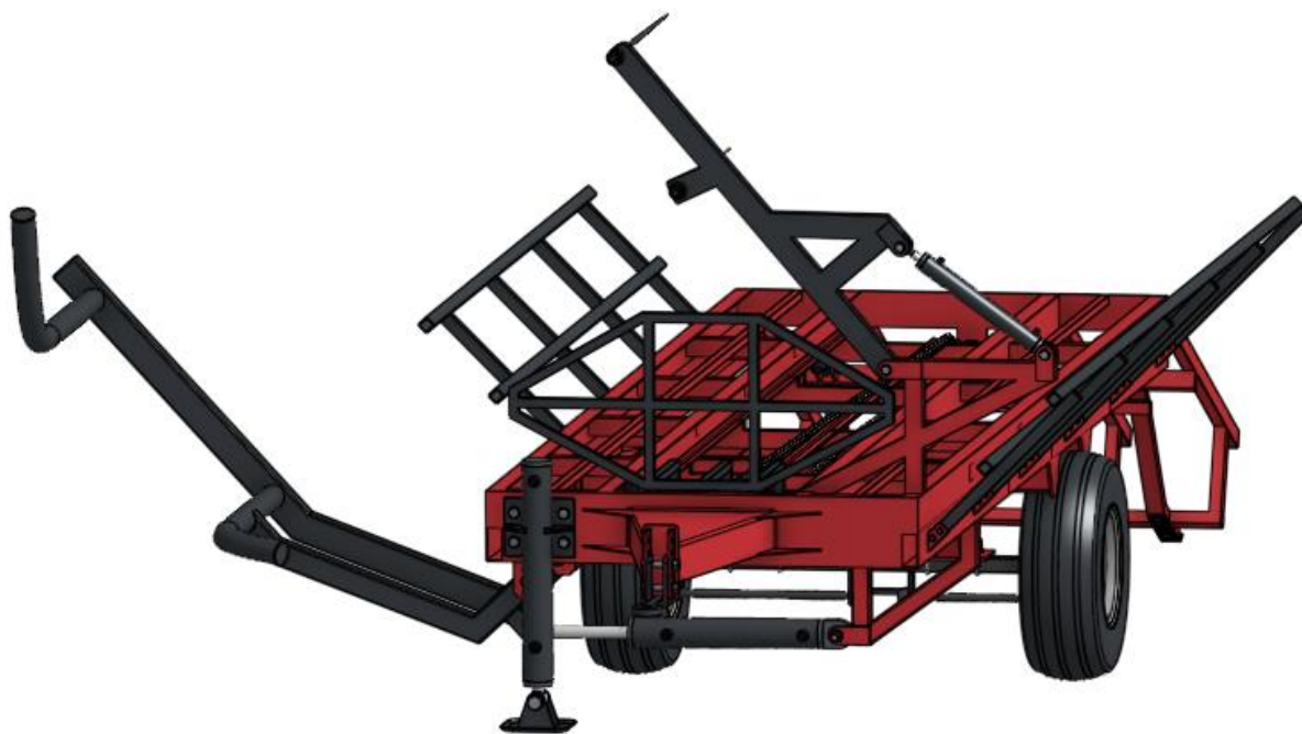
Slika 36. Princip istovara tereta preko stražnje rampe
