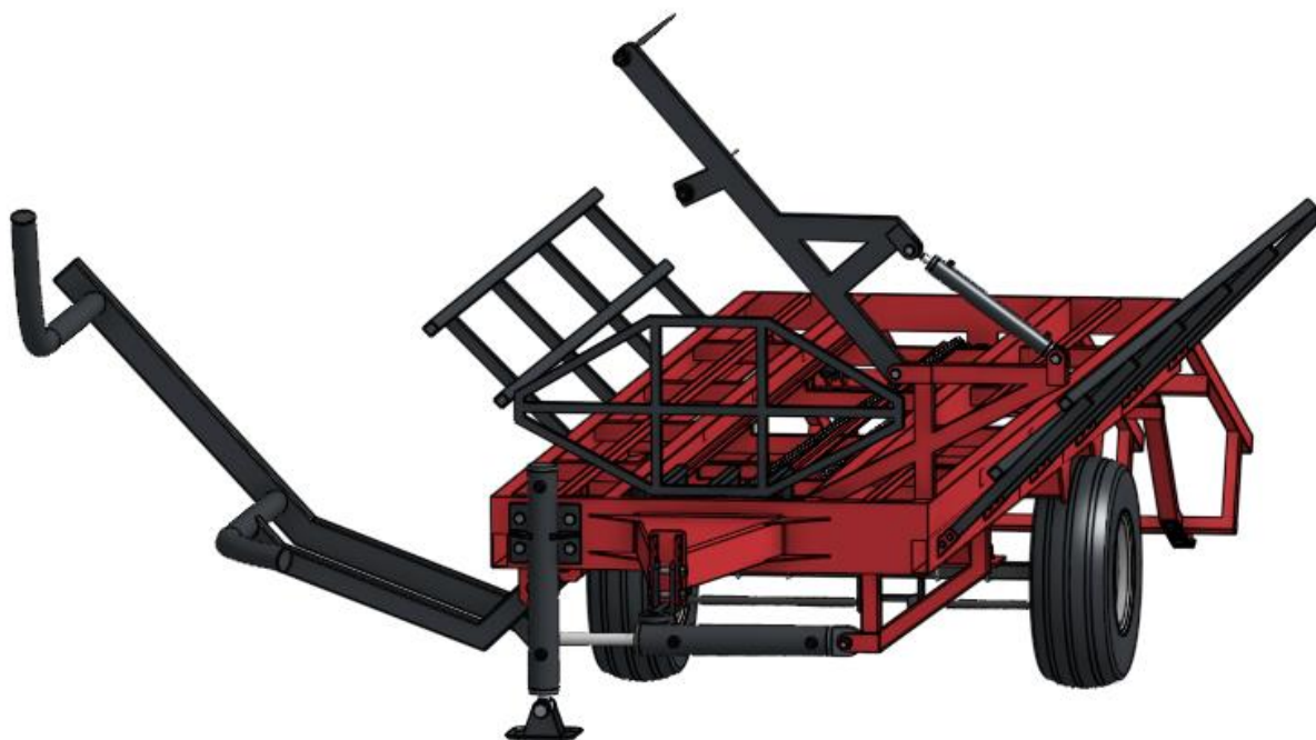
Slika 36. Princip istovara tereta preko stražnje rampe
