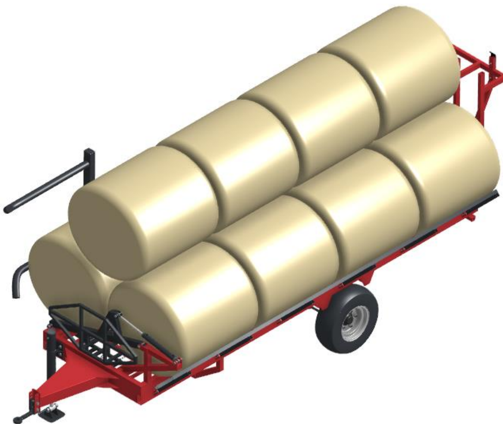
Slika 39. 3D model natovarene prikolice - 12 bala (4 - 4,5 t)
